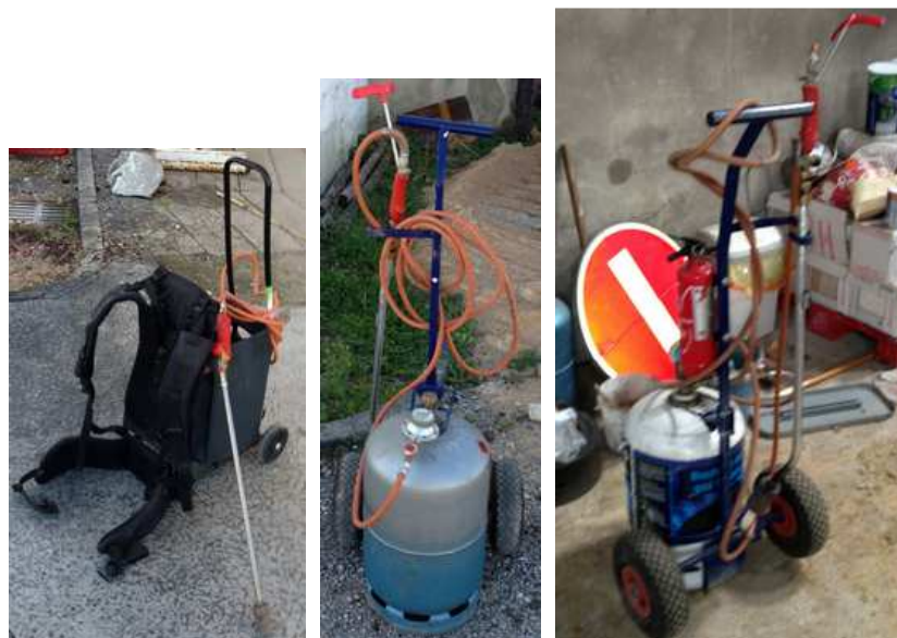
Figure 22 : Désherbeur thermiques à flamme - photos de gauche et centre : porté et trainé d'Ambérieu en Bugey ; photo de droite : trainé de Peyrouges
