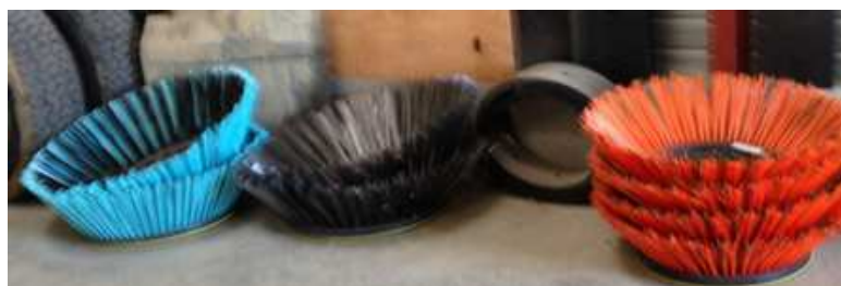
Figure 27 : Photo de gauche : différents types de brosses sur Ambérieu en Bugey (métalliques au centre et mixte sur les côtés) – Photo de droite : balayeuse d'Ambérieu en Bugey sur laquelle s'adaptent ces brosses
