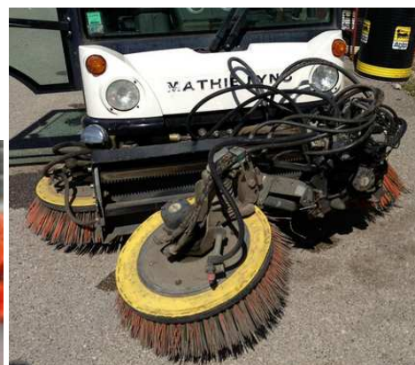
Figure 27 : Photo de gauche : différents types de brosses sur Ambérieu en Bugey (métalliques au centre et mixte sur les côtés) – Photo de droite : balayeuse d'Ambérieu en Bugey sur laquelle s'adaptent ces brosses
