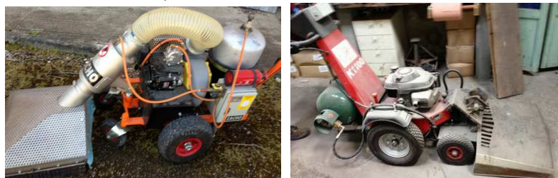
Figure 24 : Désherbeurs thermiques à infrarouges d'Ambérieu en Bugey et de Peyrouges
