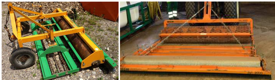
Figure 30 : Désherbeur de zones sablées (terrains en ghorre) de Grenay (photo de gauche) et d'Ambérieu en Bugey (photo de droite)
