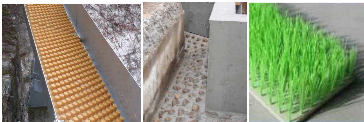
Exemple de substrat artificiel pour les passes à anguilles
