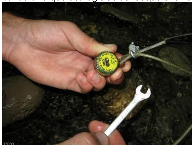
Mise en place d'une sonde Tidbit
