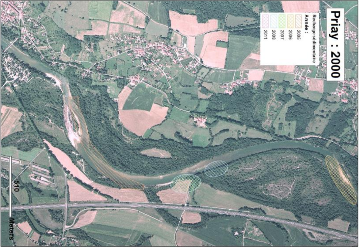
Annexe 8 : Evolution de la zone de réinjections de galets effectuées en amont de Priay entre 2005 et 2011
