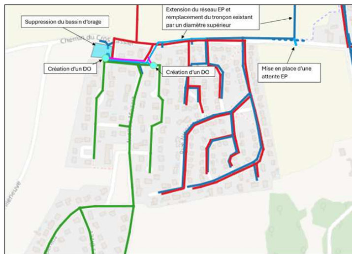
Figure 1 : Travaux de mises en séparatif – Chemin de Cros Cassier
