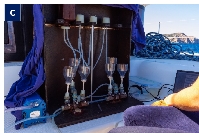
10 A: bouteille Niskin; B: filtre; C: rampe de filtration.
