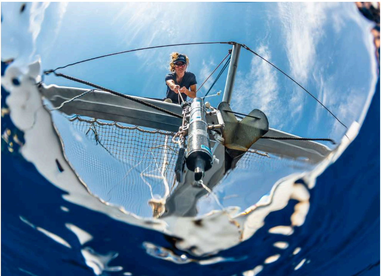
Photo 15 : Prélèvements d'eau à différentes profondeurs à l'aide d'une bouteille Niskin
