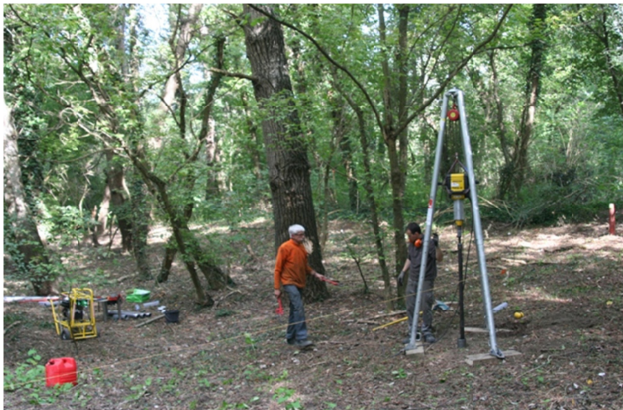
Illustration 8 : Dispositif de carottage.
