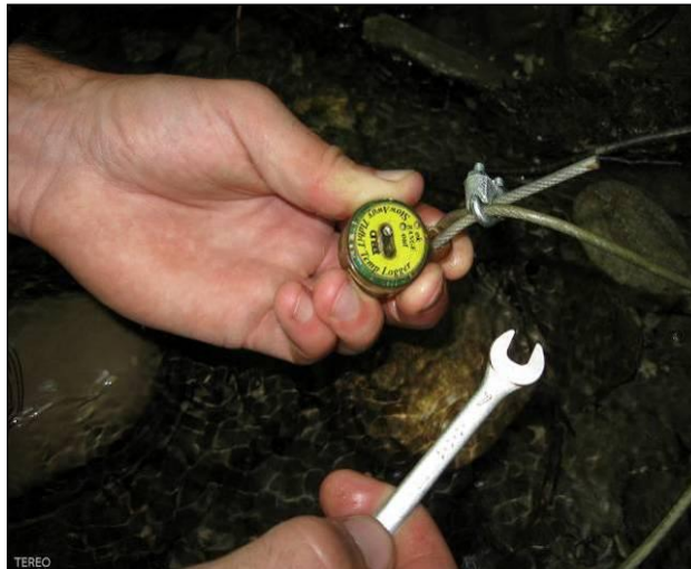
Figure 19: Mise en place d'une sonde Tidbit
