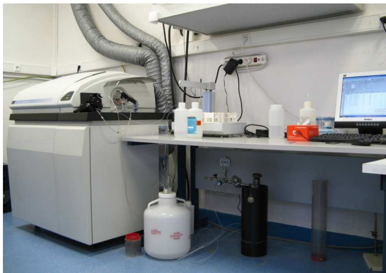
Figure 3. 6 : ICP-MS du laboratoire, Elan DRC II (Perkin Elmer), avec le passeur automatique positionné sous une hotte à flux laminaire (photo G. Féraud).
