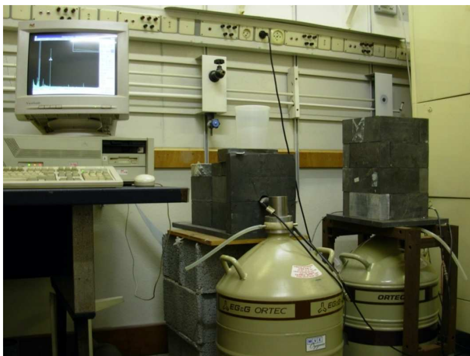
Figure 3. 10 : Spectromètres gamma (Ortec) utilisés au laboratoire LRSAE
