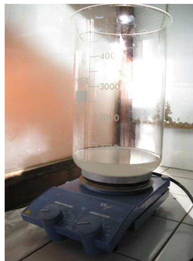
Figure A 24 : Précipitation du précipité de \text{BaSO}_4 : coprécipitation sélective du radium
