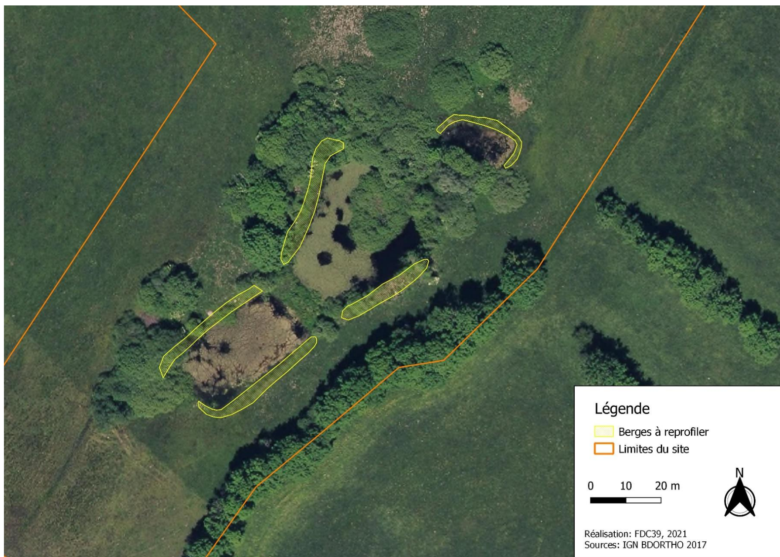
Figure 24 Localisation des berges à reprofiler
