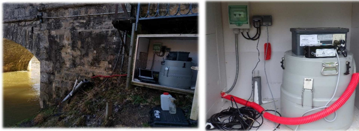
Photographie 2: Dispositif de prélèvement sur la station de Chenecey-Buillon.
