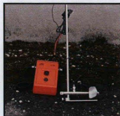
Figure 13 : Moulinet pour relever les vitesses
