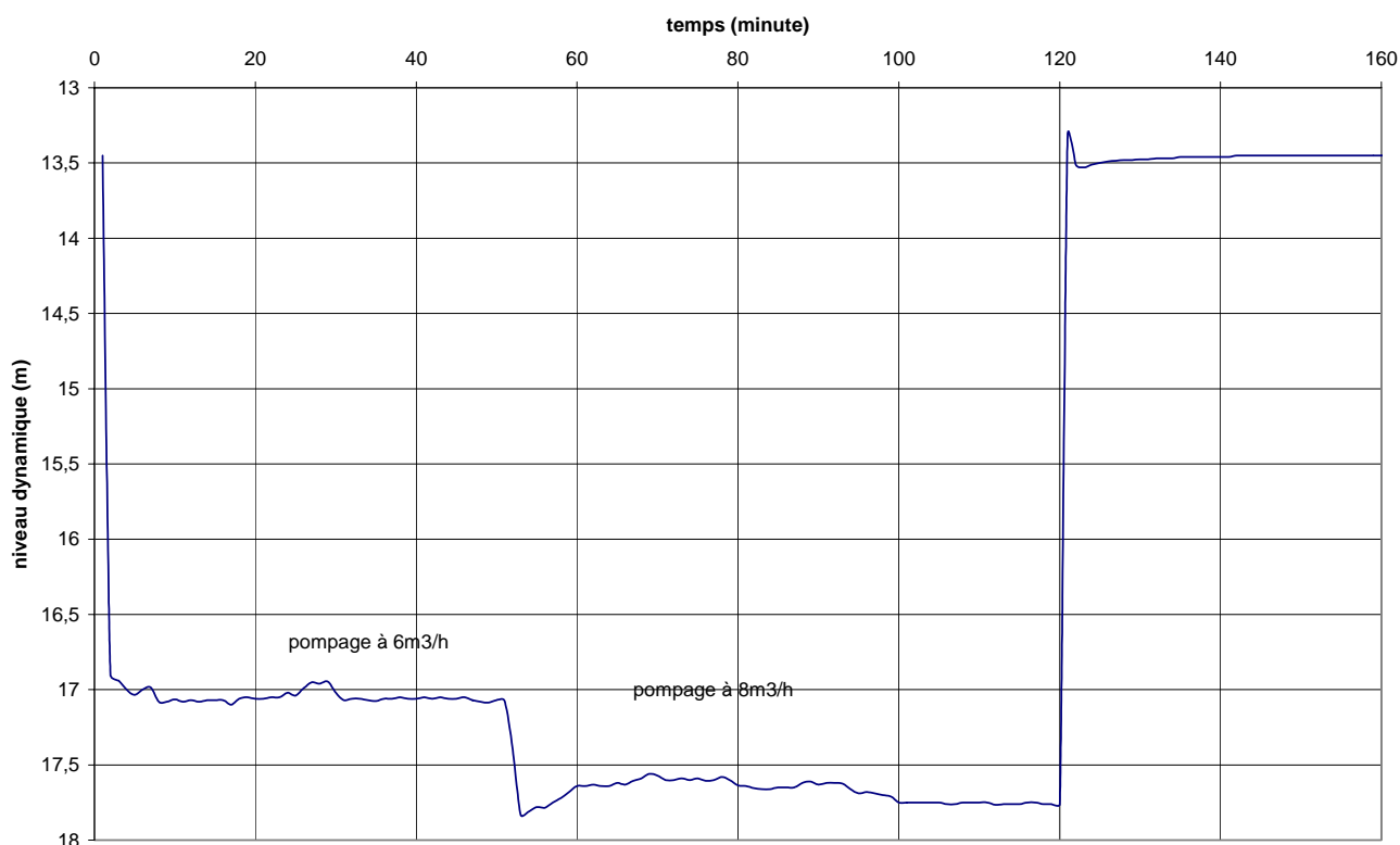
Figure 6 : suivi du niveau d'eau dans le piézomètre 6 durant le pompage d'essai
