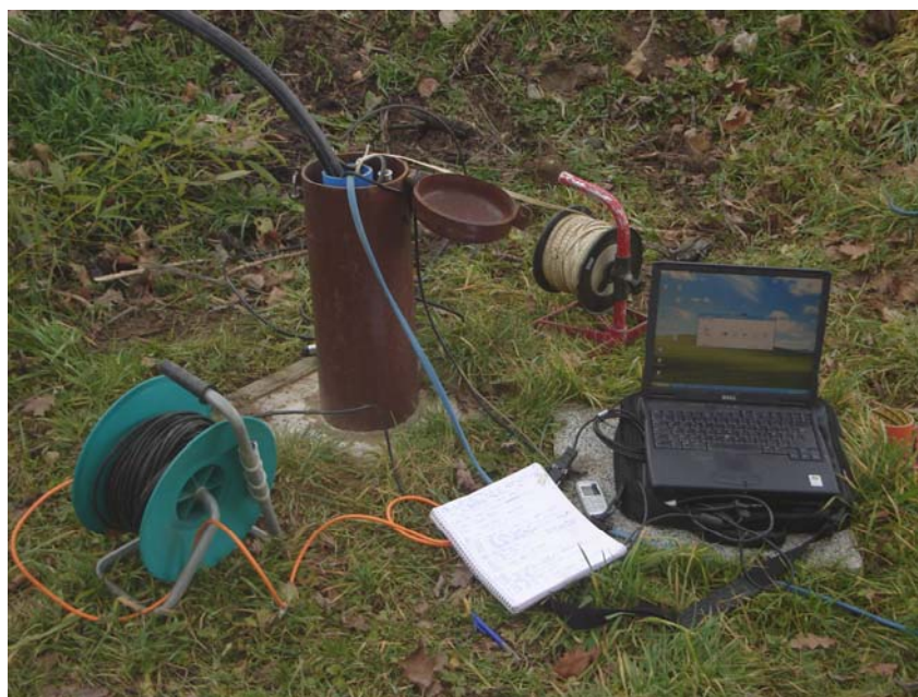
dispositif mis en place sur le piézomètre N°9
