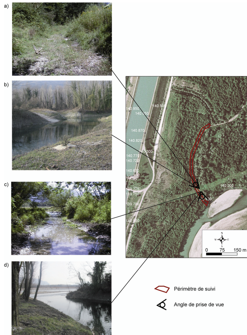
Figure 4-31. Périmètre de suivi de la lône de la Malourdie (Orthophoto IGN 2001). a) chenal avant curage (photo CNR, 2000), b) chenal restauré (photo de février 2005, cliché personnel), c) connexion aval avant les travaux de déblais (photo CNR, 2000), d) connexion aval restaurée (photo février 2005, cliché personnel)
