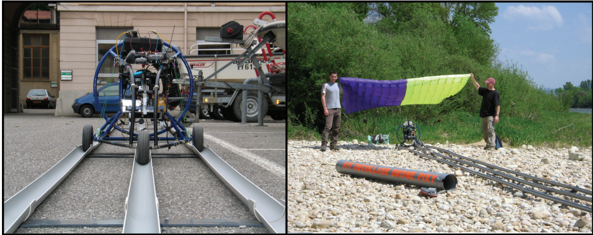
Figure 3-2. Rampe de lancement drone « tri-tube » et son installation in situ
