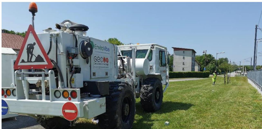
Figure 4 : Camion vibrateur Envirovibe IVI Mark II
