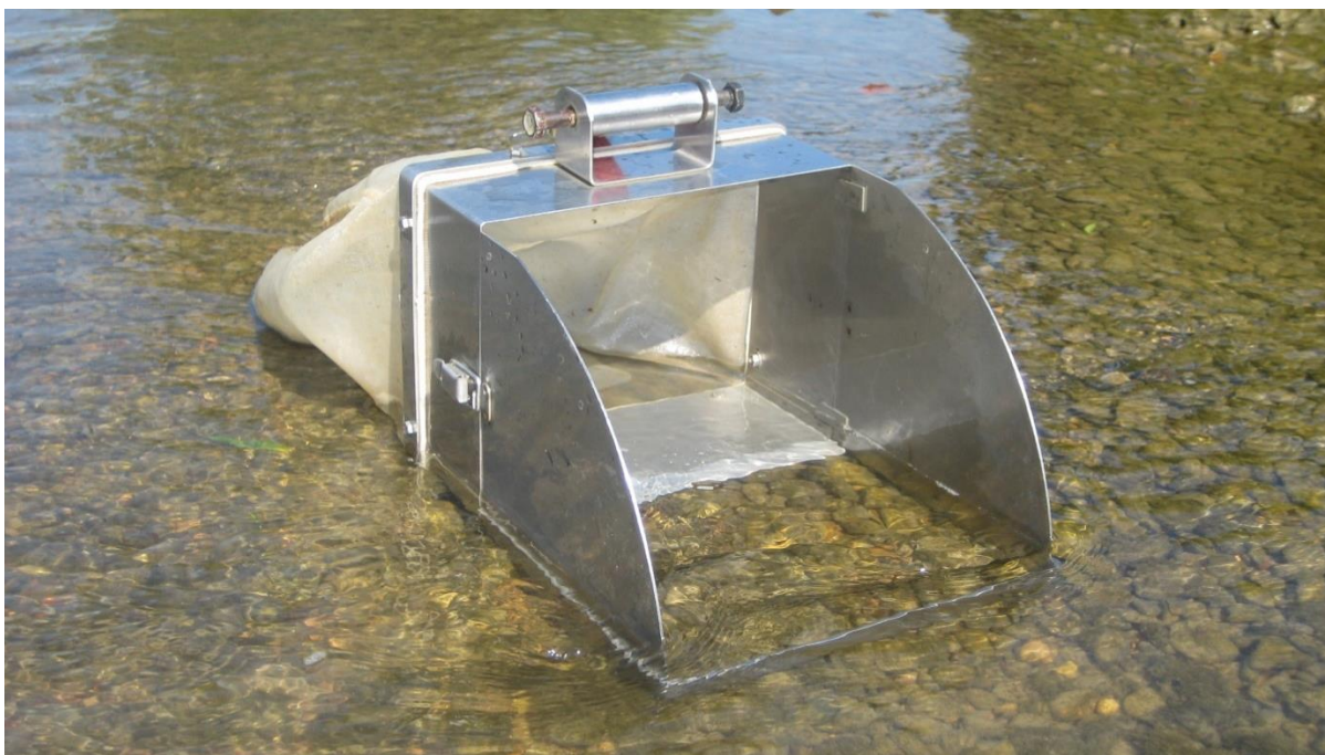
Figure 2.6 : le sürber (1/20 ème de m 2 et filet de 500 µ) outil de prélèvement normalisé commun aux deux campagnes d'analyses benthiques.
