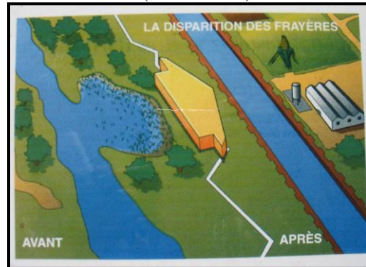
Figure 45: Schéma de la chenalisation d'un fleuve (SMTC 2006)
