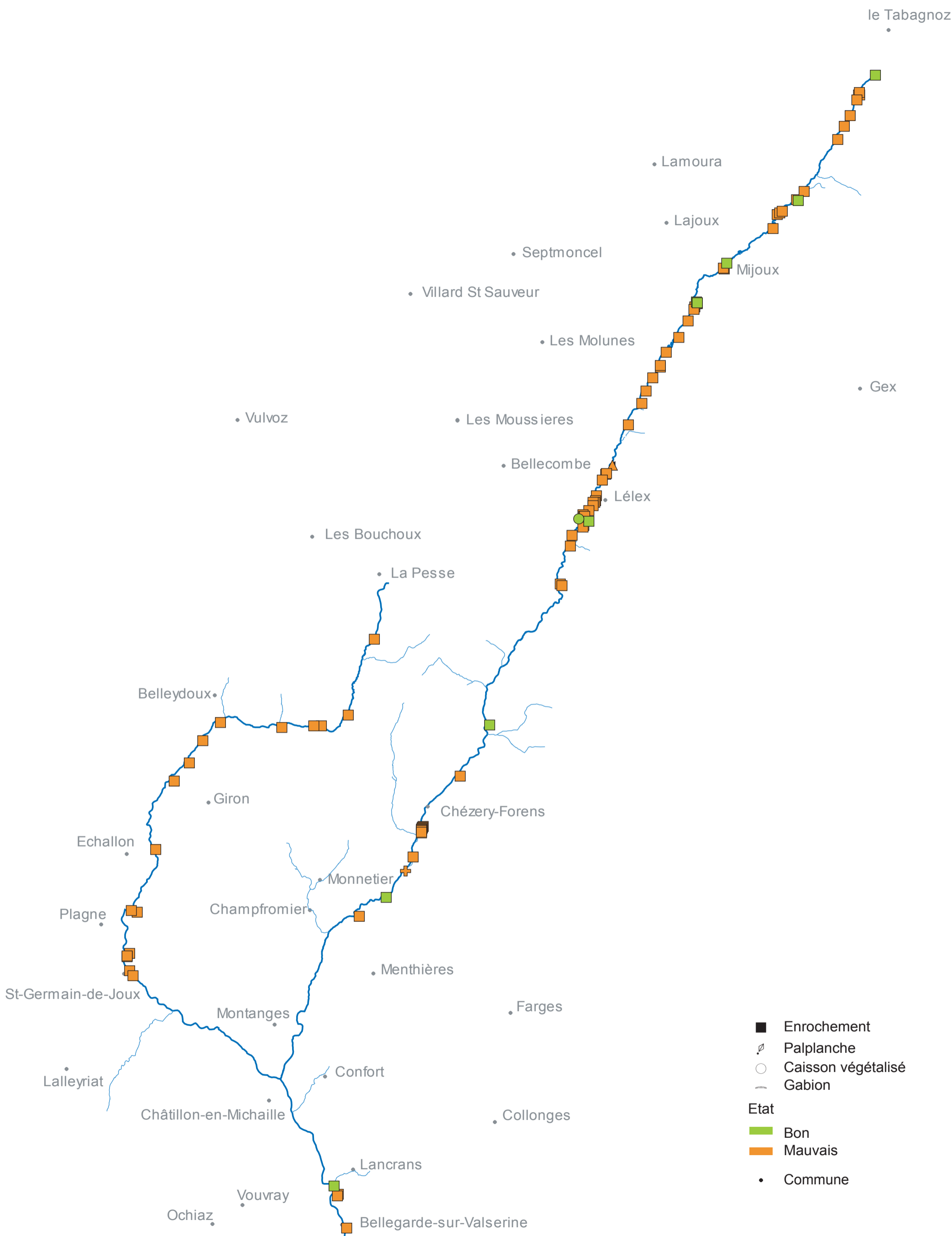
Planche 16 : Localisation et état des principales protections de berges sur la Semine et la Valserine
