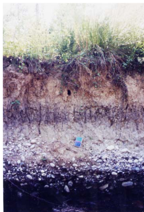
Le Renom en amont de « Dagallier bas » Hauteur de berge environ 2 m. Stratification plus complexe : 50 cm supérieurs en limon-argileux très cohésif. 70-80 cm argilo-limoneux avec quelques petites strates sablo-limoneuses (nid de martin-pêcheur). 50 cm inférieurs en PGPFCG dans une matrice sableuse très peu cohésive.
