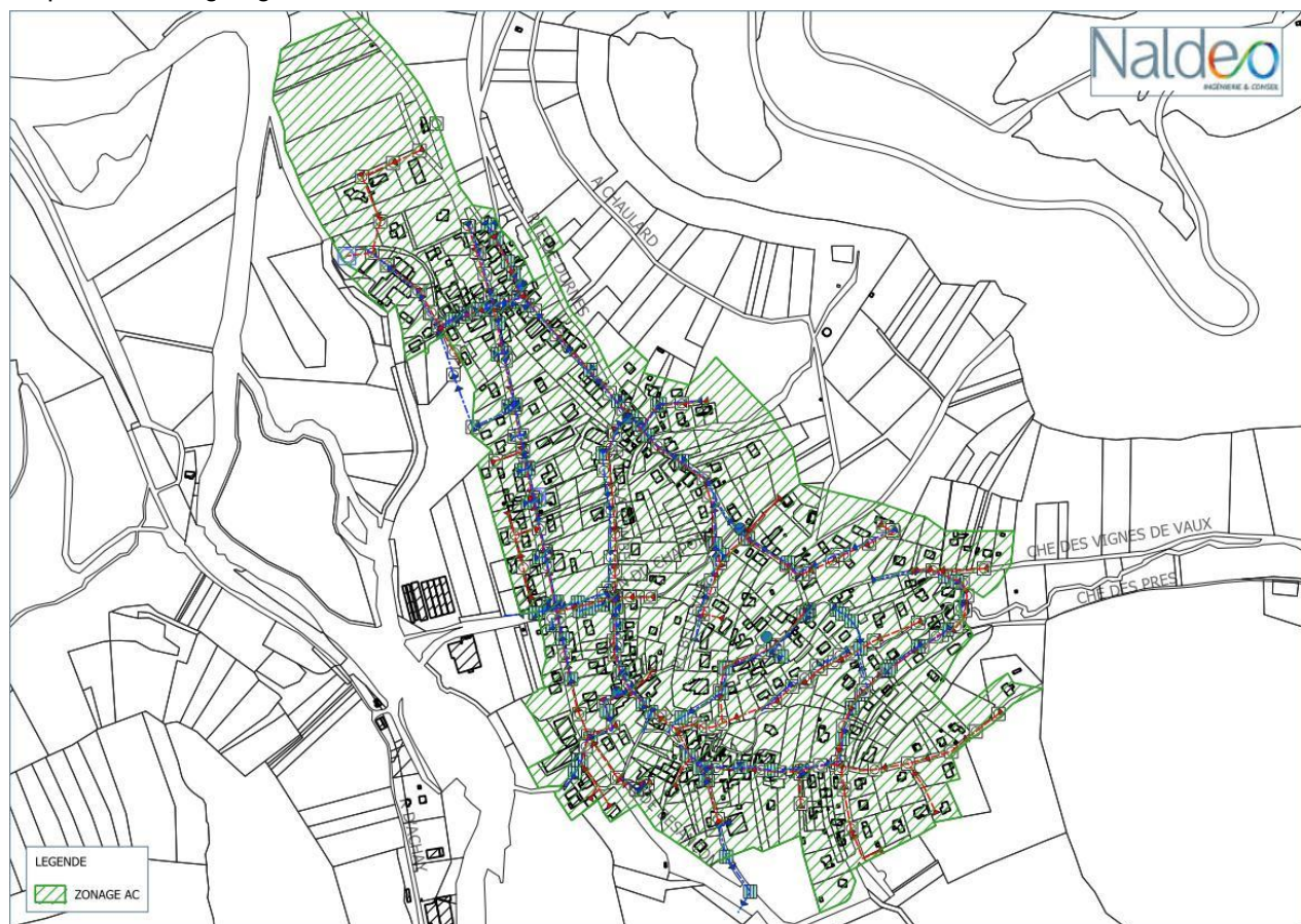
Zonage assainissement collectif de Montgesoye
