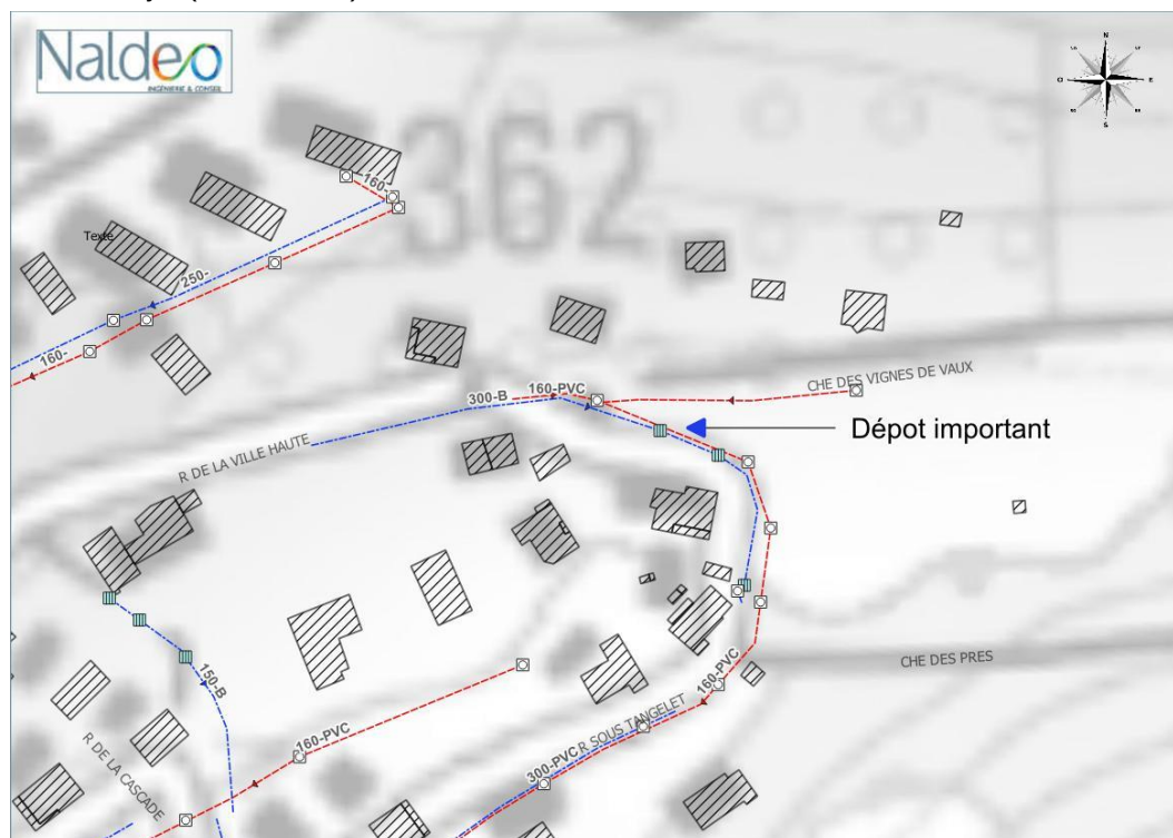
Dépôt important à nettoyer au niveau d'une grille de collecte
