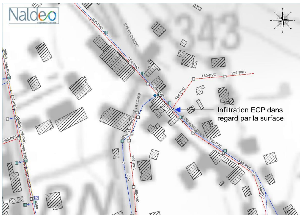
Localisation infiltration ECP
