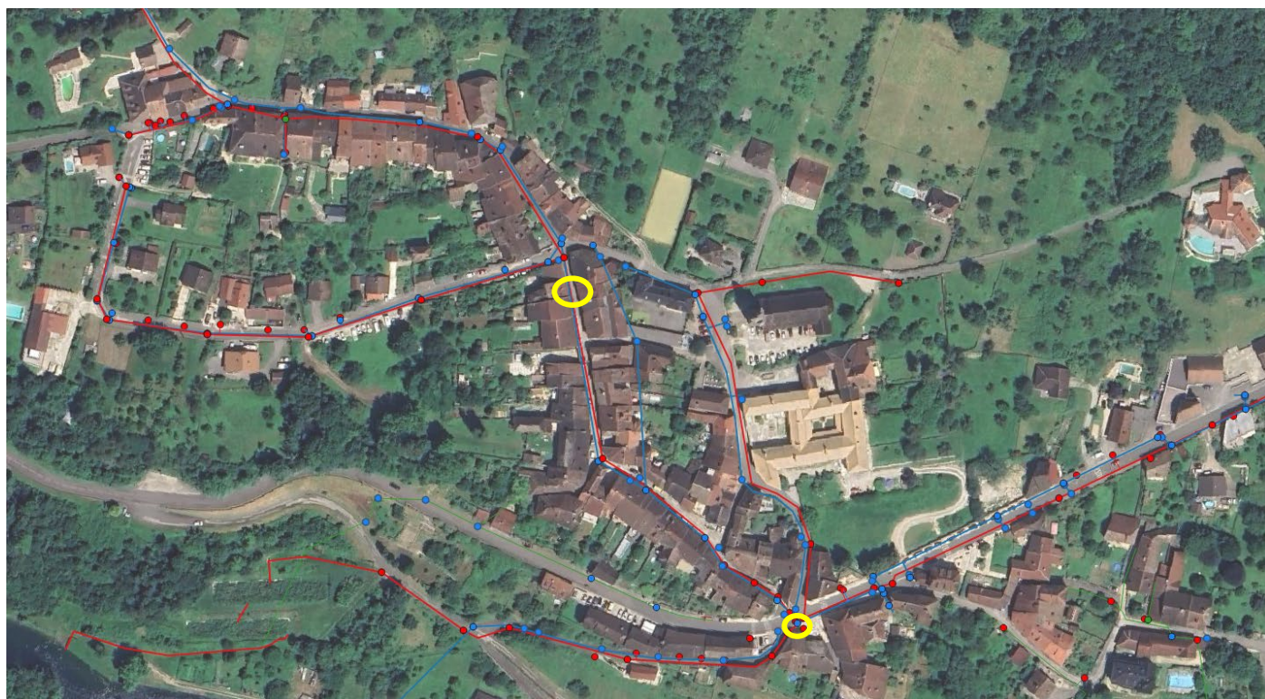
Figure 1 : Localisation des anomalies du réseau d'eaux usées à supprimer
