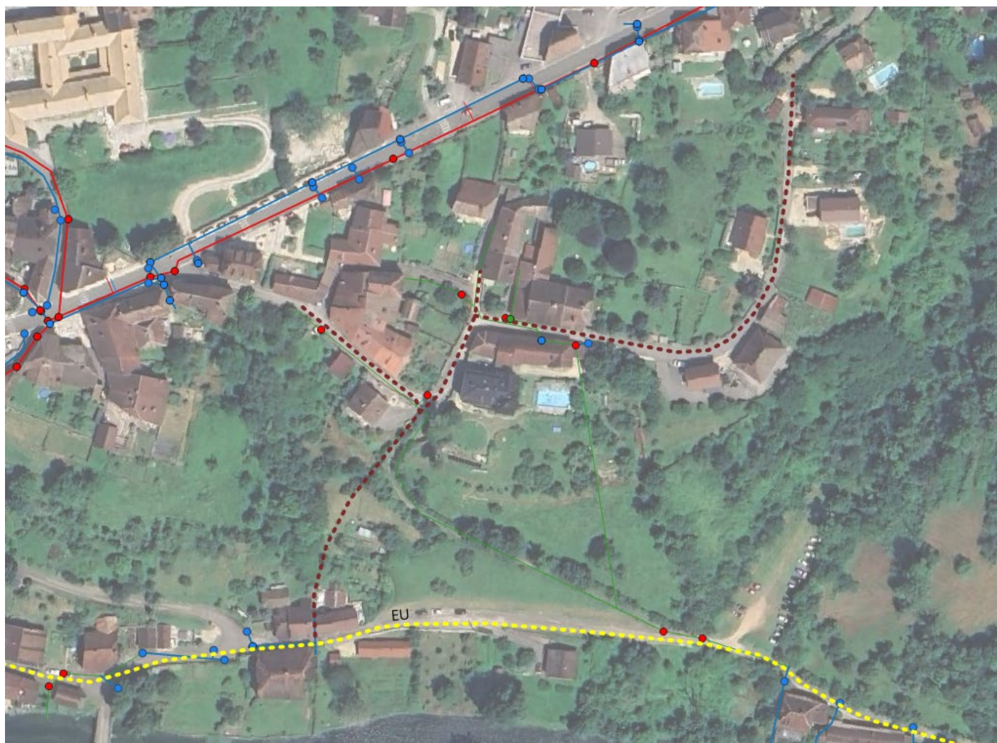
Figure 15 : Création d'un réseau d'eaux usées pour le raccordement de la rue Reyer
