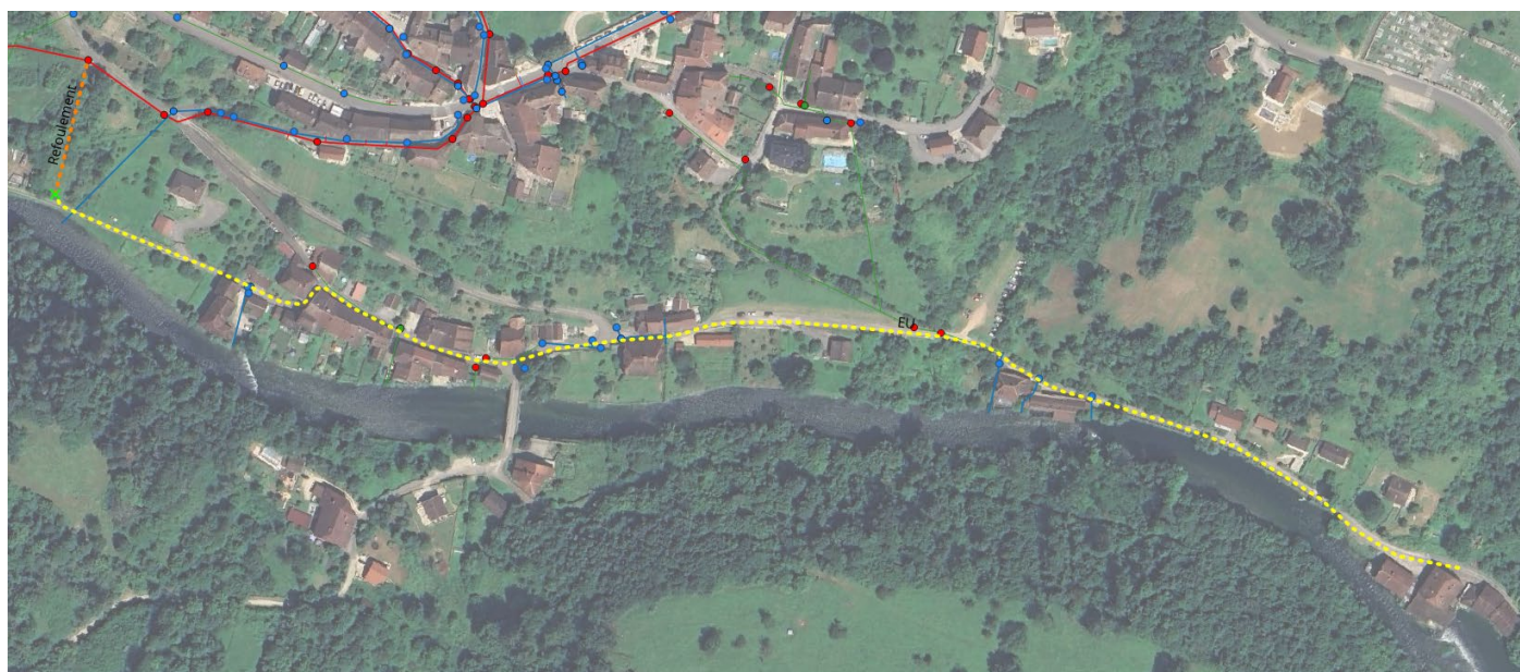
Figure 13 : Création d'un réseau d'eaux usées pour le raccordement de la partie basse du village
