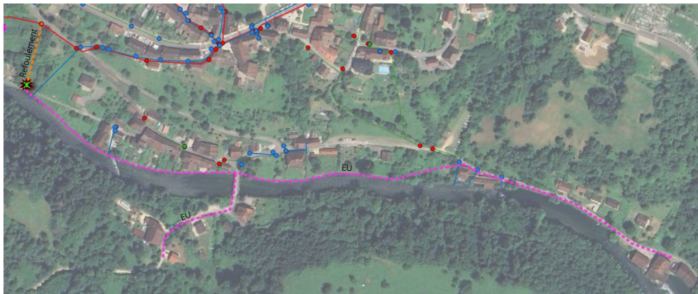
Figure 8 : Création d'un réseau d'eaux usées pour le raccordement de la partie basse du village
