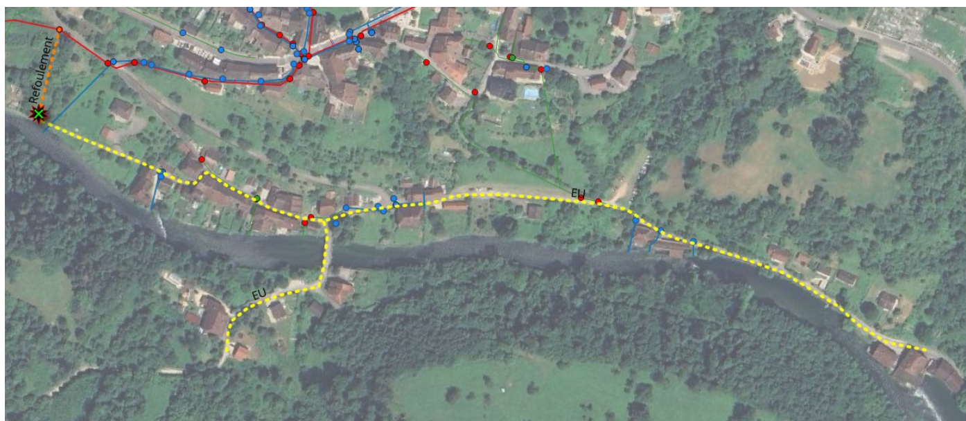
Figure 6 : Création d'un réseau d'eaux usées pour le raccordement de la partie basse du village
