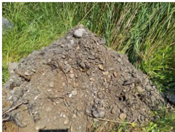
0.4-1.35m : remblai : galets toutes tailles à matrice sablo-argileuse grise, bloc et morceaux de bois
