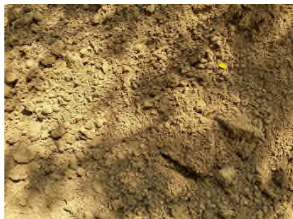
0.4-0.8m : limon sableux beige à quelques galets toutes tailles
