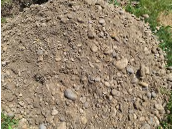
1.7-2.3m : petits et moyens galets à matrice sableuse grise
