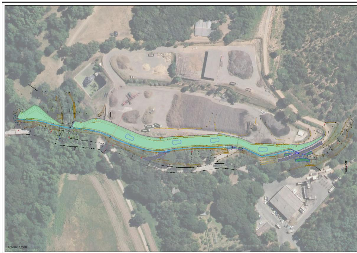
Figure 28 : Vue en plan du lit emboîté en RD
