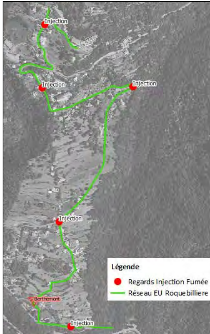
Illustration 21 : points d'injection fumée - Système de Berthemont
