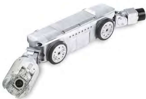
Illustration 26 : Chariot utilisé pour les inspections télévisées
