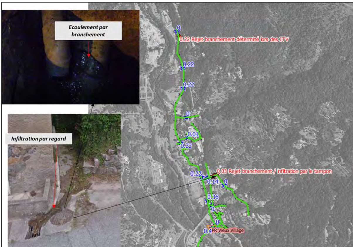
Illustration 18 : Entrées d'eaux claires Amont PR Vieux Village
