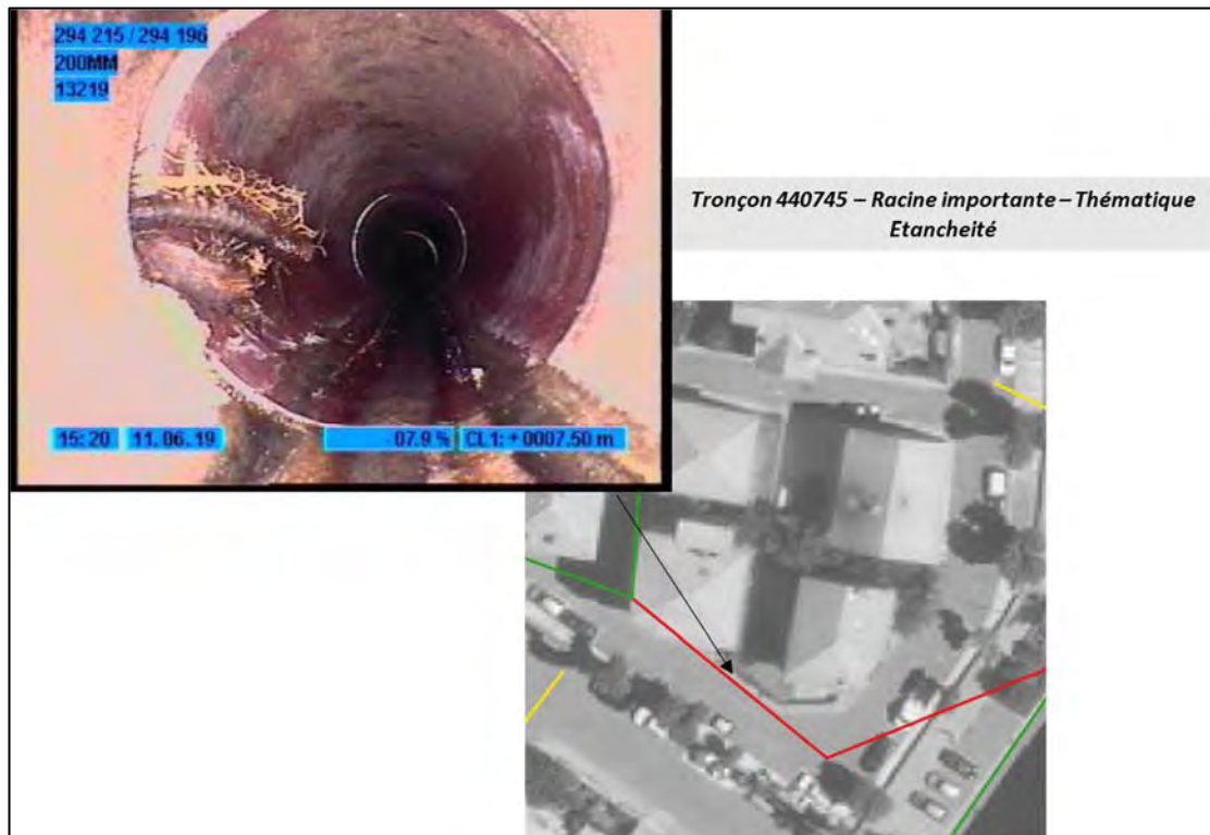
Illustration 37 : Exemple thématique « Étanchéité » – Racine et fer à béton sur réseau en grès.
