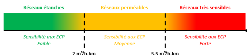
Illustration 16 : classification de la sensibilité des réseaux aux eaux claires parasites en fonction du linéaire
