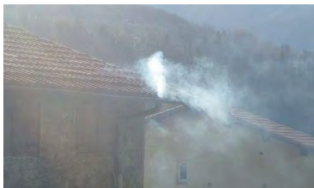
Illustration 19 : identification d'anomalie par tests à la fumée : ici, mauvais raccordements de gouttières
