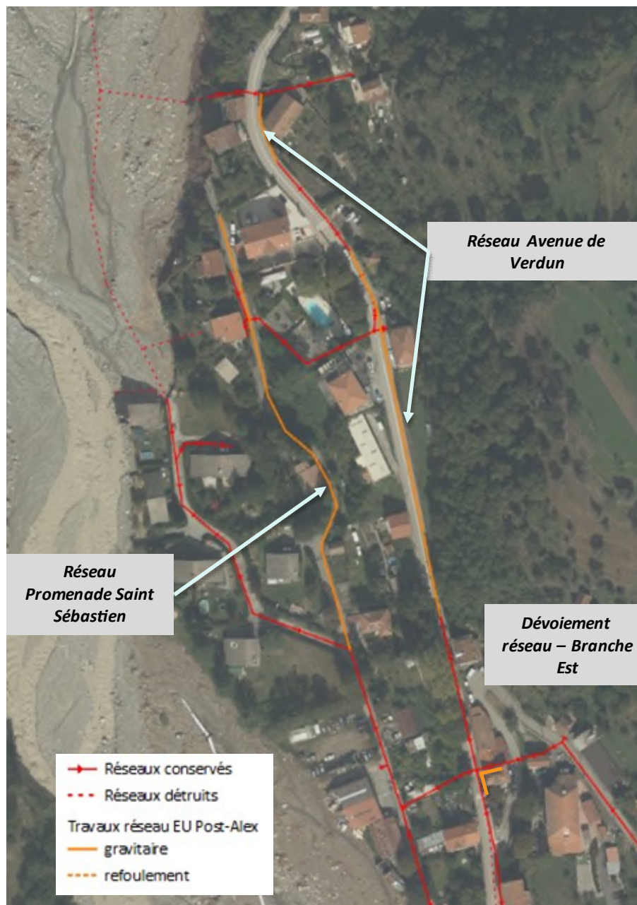
Illustration 19 : travaux réseaux EU Post-Alex - secteur Nord Vieux-Village Roquebillière
