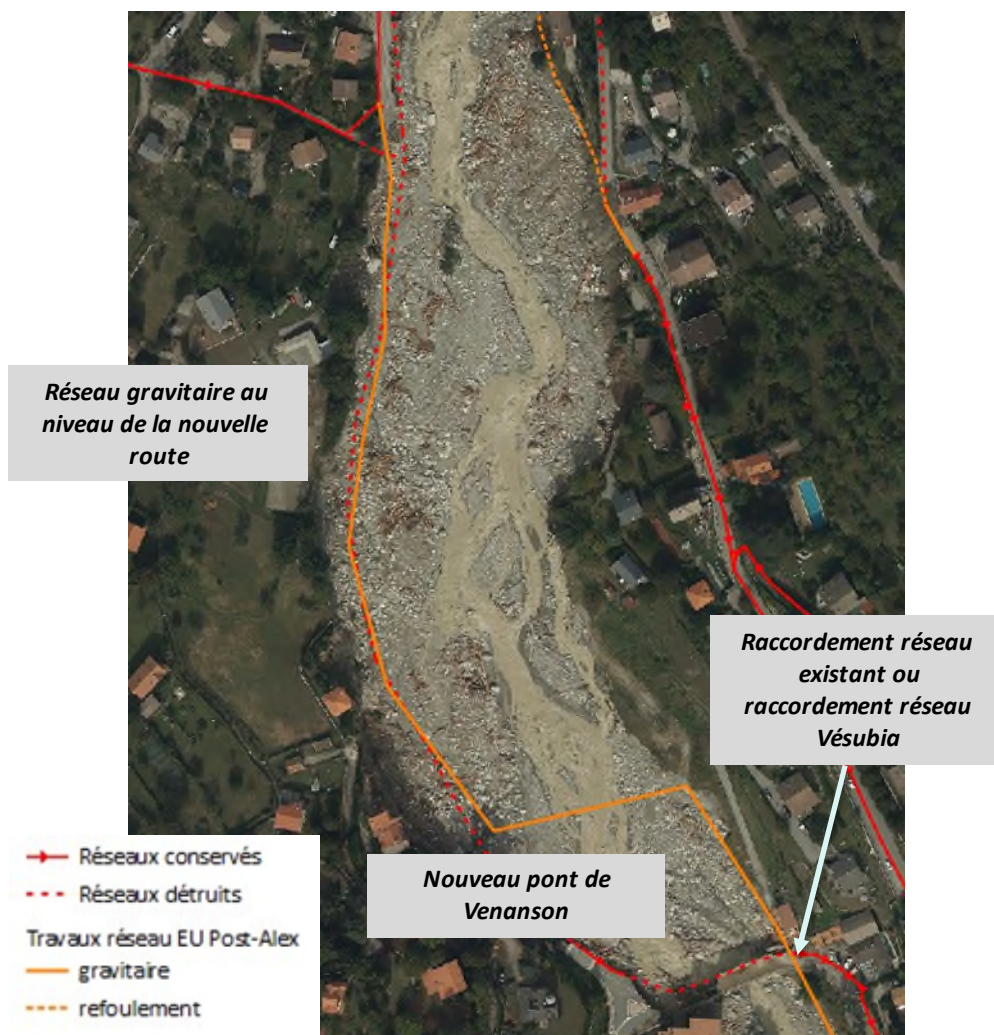
Illustration 9 : Plan de principe réseau EU rive droite Boréon après travaux
