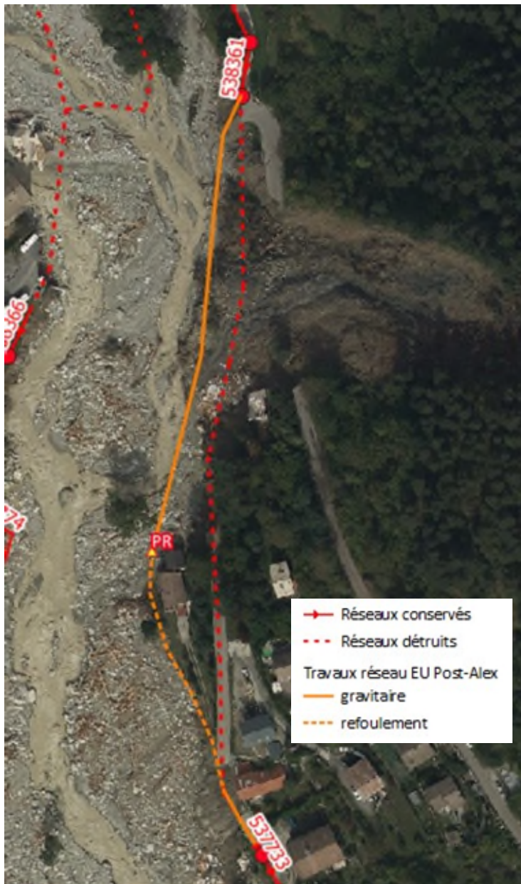
Illustration 7 : Plan de principe des ouvrages de réhabilitation de la casse 3 – Rive Gauche Boréon
