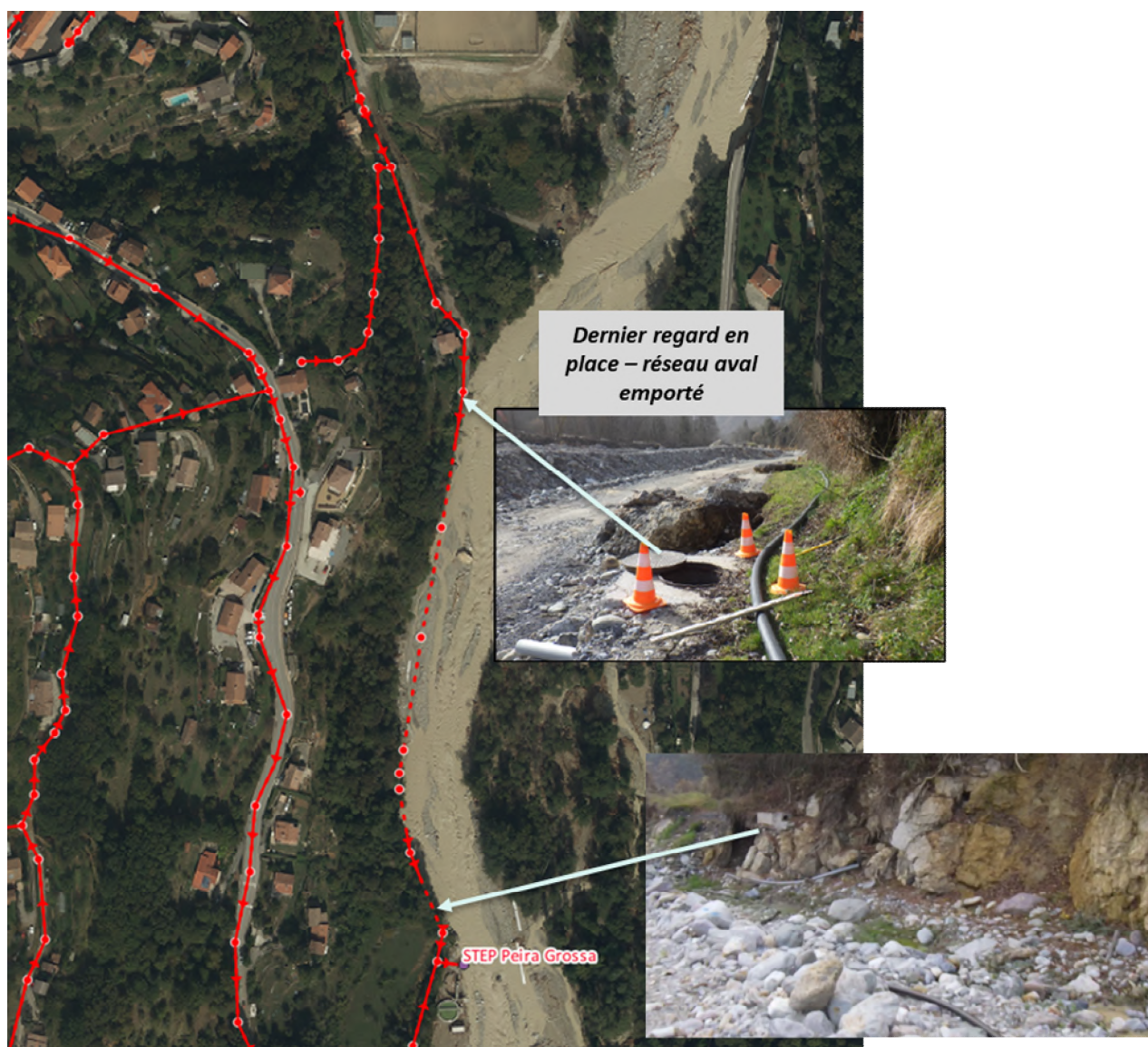
Illustration 22 : Diagnostic EU Post-Alex - réseau transfert amont STEP Peïra Grossa
