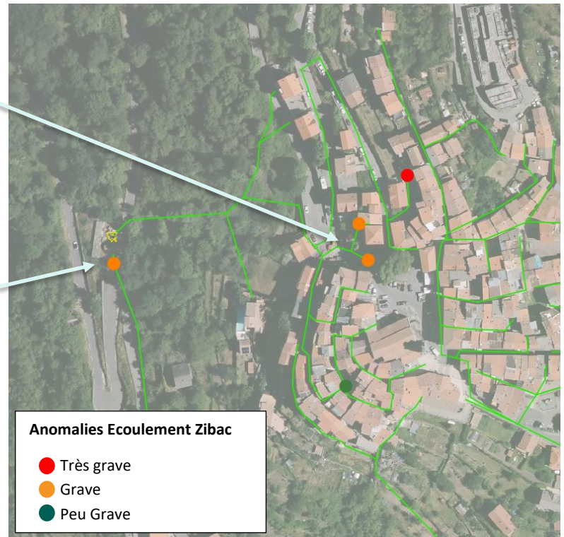
Illustration 26 : Répartition des anomalies « Défauts d'écoulement » avec classe de gravité – Système du Zibac
