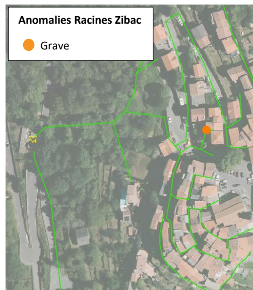
Illustration 33 : Anomalie "Présence de racines" grave - Système du Zibac
