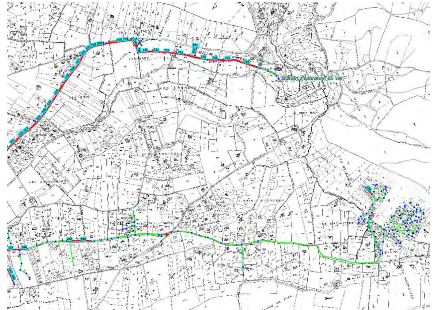
Figure 35: Aperçu cartographique des zones proposées pour l'inspection télévisée, secteur nord-est avant la station d'épuration
