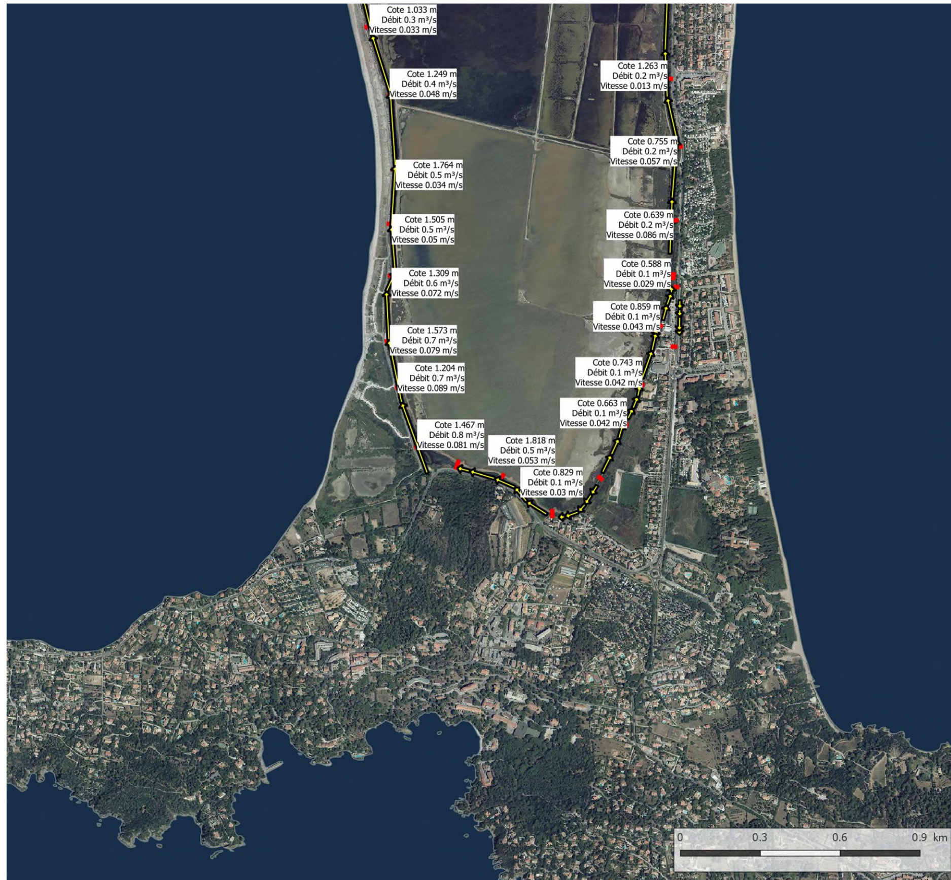
FIGURE 21 - FONCTIONNEMENT HYDRAULIQUE DU SALIN DES PESQUIERS POUR UNE PLUIE MENSUELLE – PARTIE SUD
