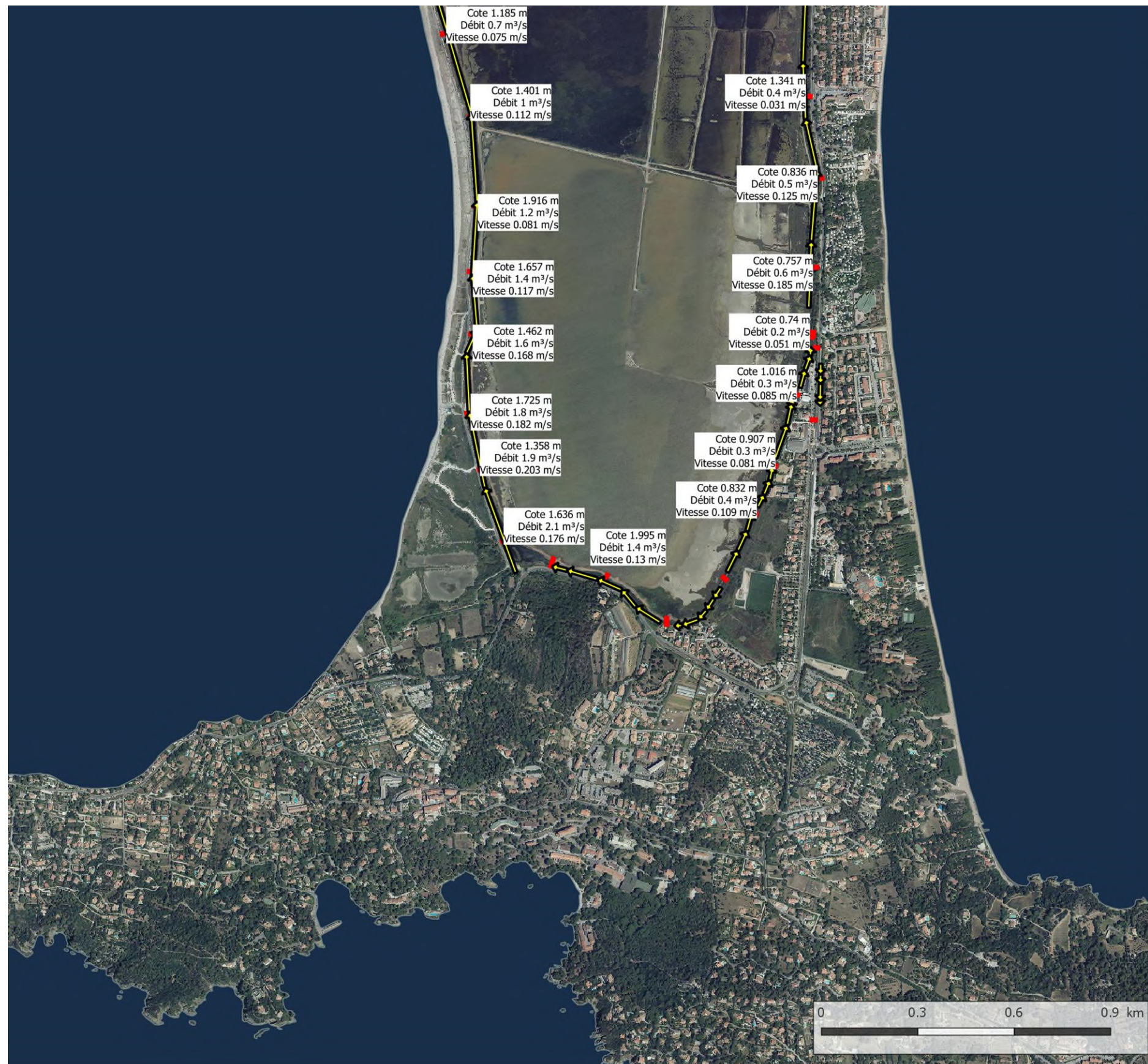
FIGURE 23 - FONCTIONNEMENT HYDRAULIQUE DU SALIN DES PESQUIERS POUR UNE PLUIE ANNUELLE – PARTIE SUD
