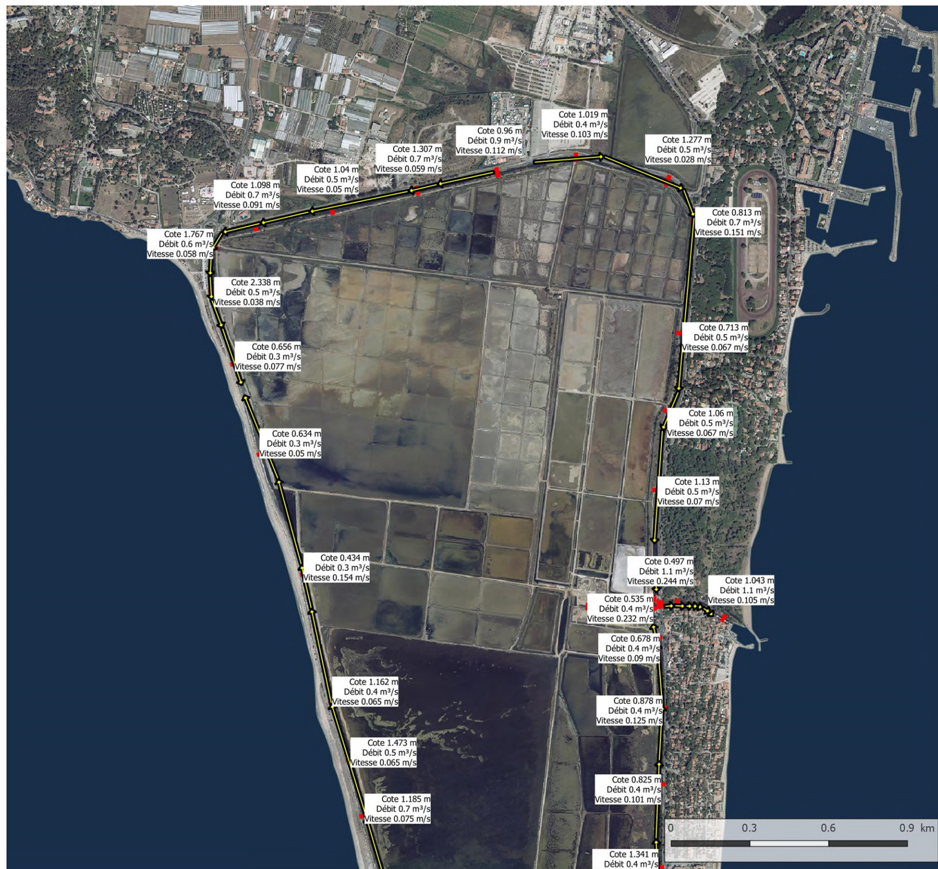
FIGURE 22 - FONCTIONNEMENT HYDRAULIQUE DU SALIN DES PESQUIERS POUR UNE PLUIE ANNUELLE – PARTIE NORD
