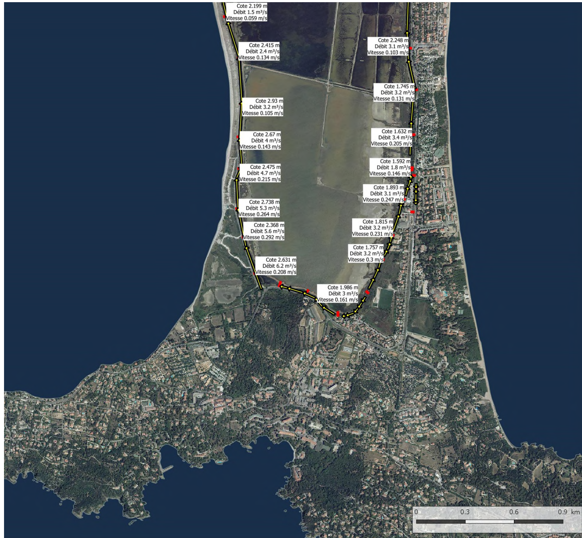
FIGURE 25 - FONCTIONNEMENT HYDRAULIQUE DU SALIN DES PESQUIERS POUR UNE PLUIE DECENNALE – PARTIE SUD
