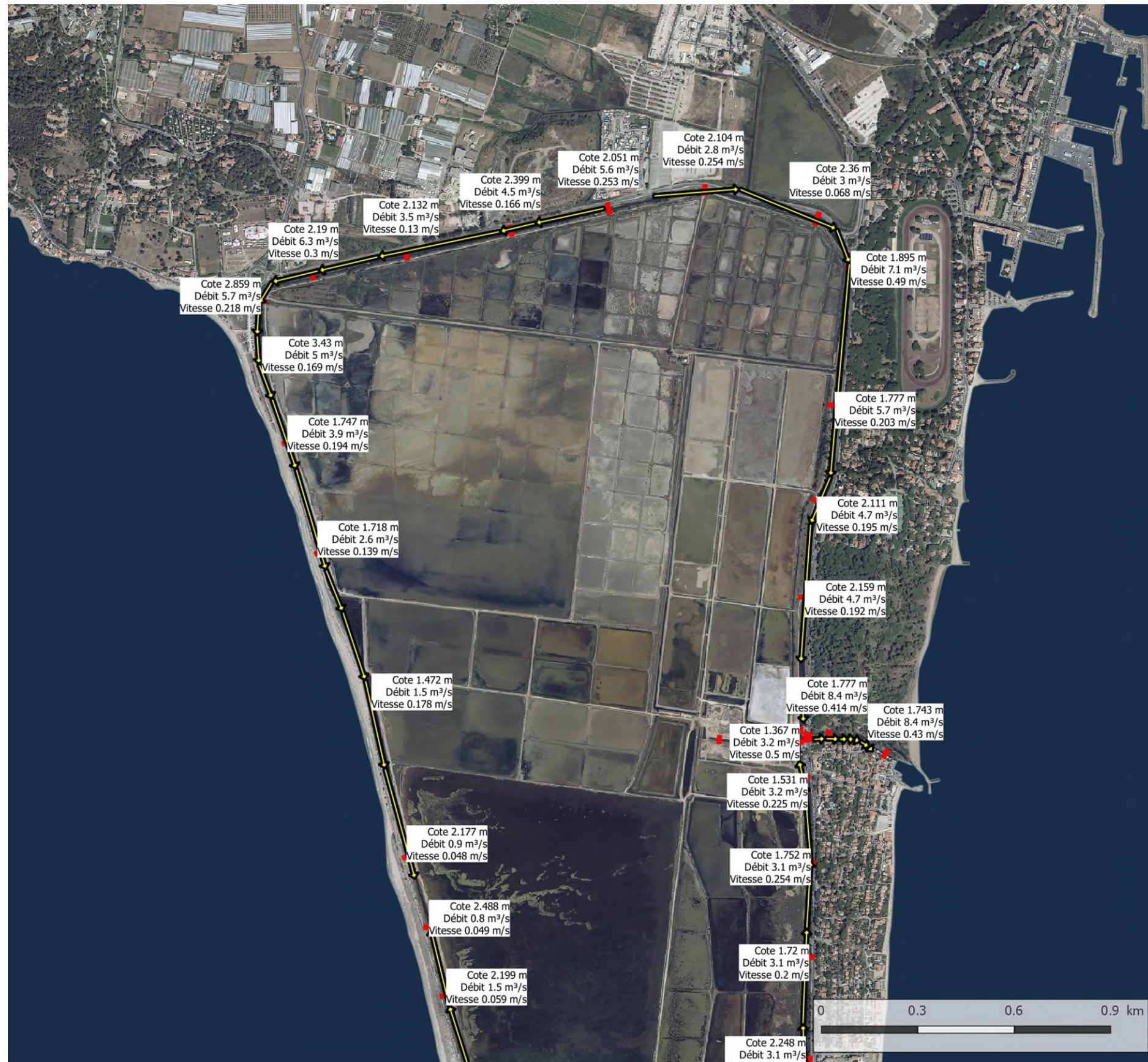
FIGURE 24 - FONCTIONNEMENT HYDRAULIQUE DU SALINS DES PESQUIERS POUR UNE PLUIE DECENNALE – PARTIE NORD
