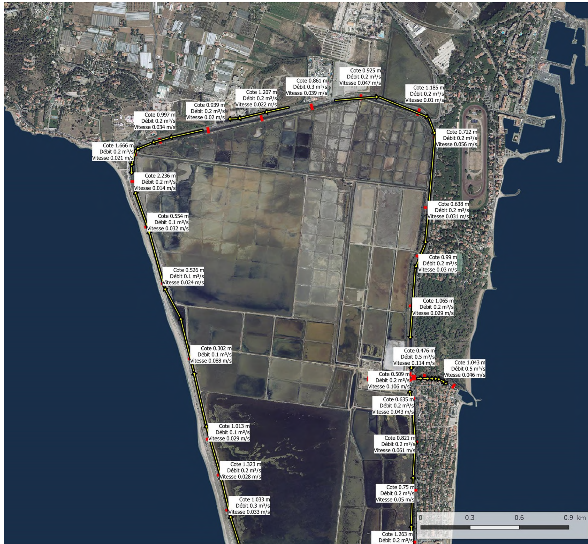
FIGURE 20 - FONCTIONNEMENT HYDRAULIQUE DU SALIN DES PESQUIERS POUR UNE PLUIE MENSUELLE – PARTIE NORD
