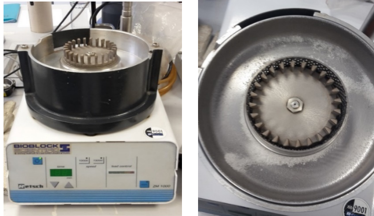
Figure 10 : Broyage des polymères (LDPE, PET, PVC, PS) à l'aide d'un broyeur ultra-centrifuge
