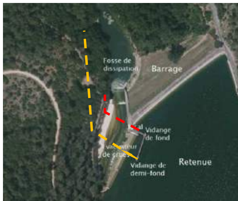
Figure 2 : vue schématique des principaux organes de l'ouvrage
