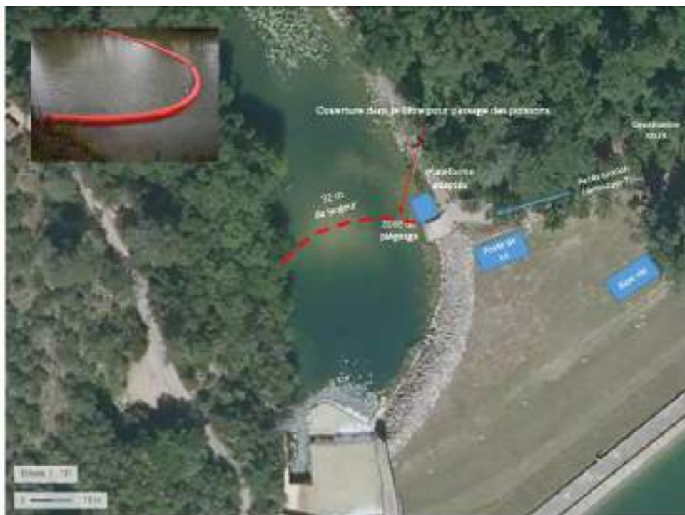
Figure 3 : Emplacement du filtre à MES
