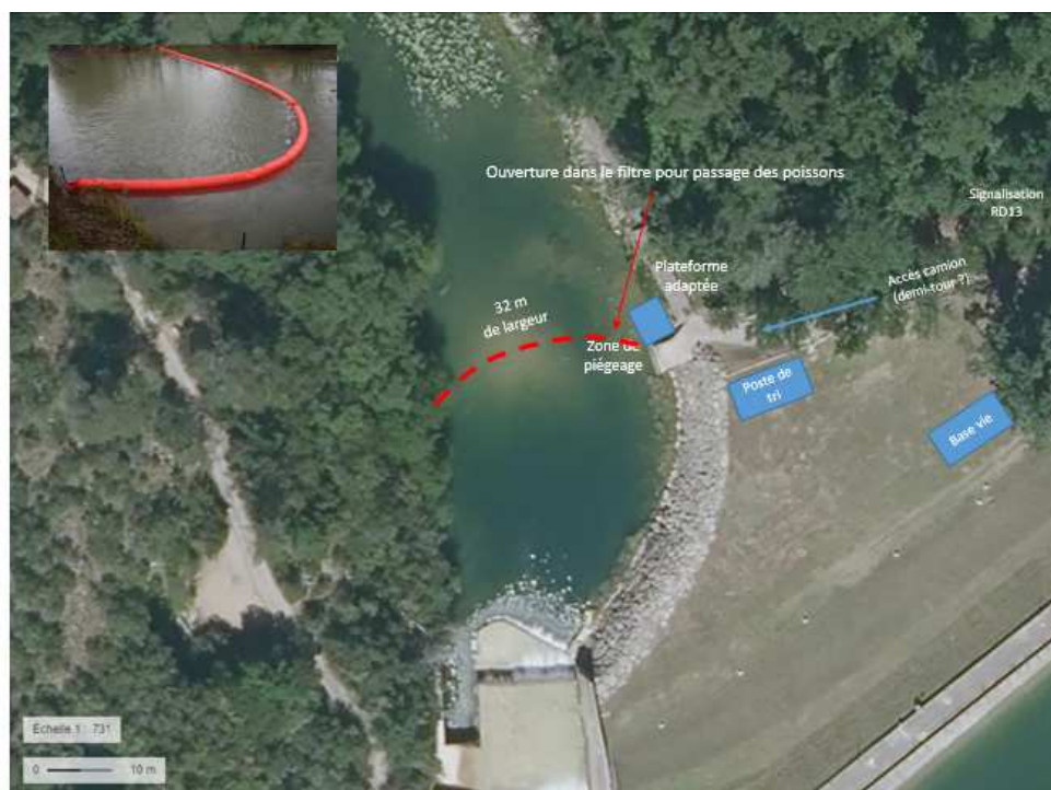
Figure 3 : Emplacement du filtre à MES
