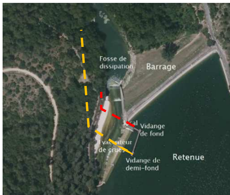
Figure 2 : vue schématique des principaux organes de l'ouvrage
