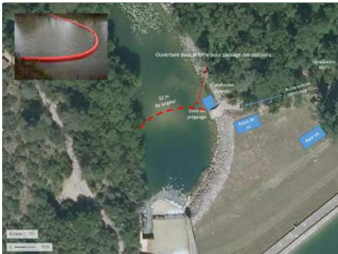
Le barrage anti-MES sera couplé à un barrage flottant anti-pollution. Si besoin, les deux barrages peuvent être détachés l'un de l'autre et le barrage anti-pollution posé en aval du barrage anti-MES.
