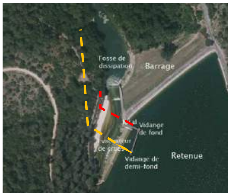
Figure 95 : vue schématique des principaux organes de l'ouvrage
