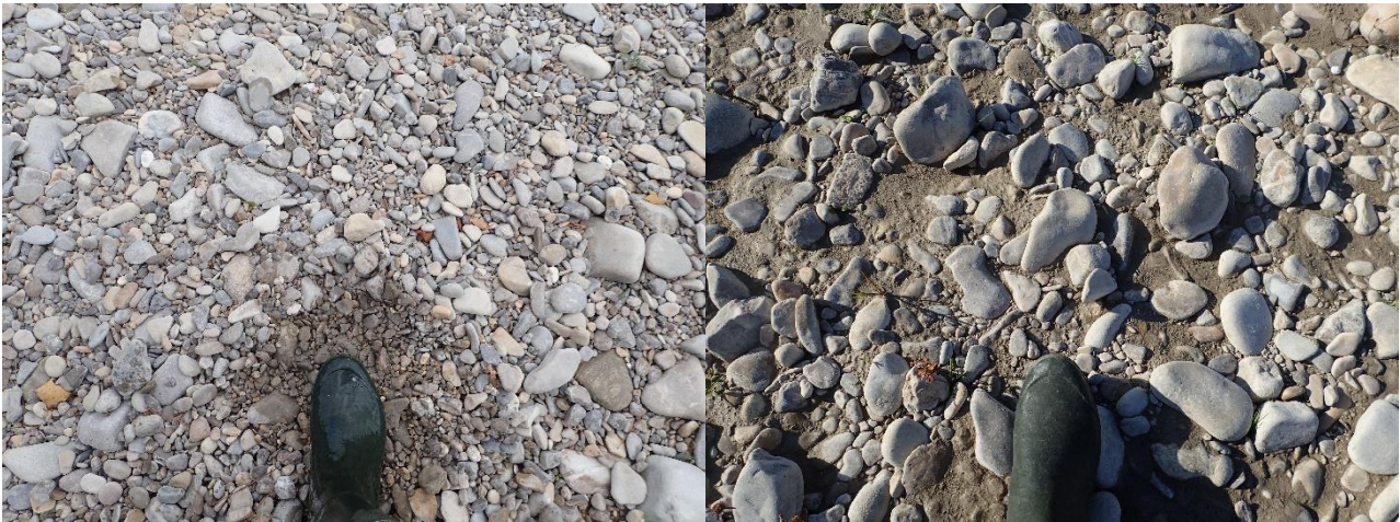
Figure 21 : Photographies de fractions granulométriques observées. Photographie de gauche : granulométrie entre 25 et 35 mm. Photographie de droite : granulométrie structurante 40 et 90 mm.
