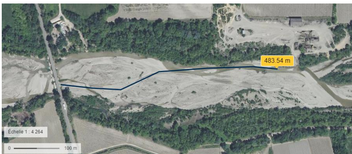
Illustration du développement de l'érosion régressive potentielle
