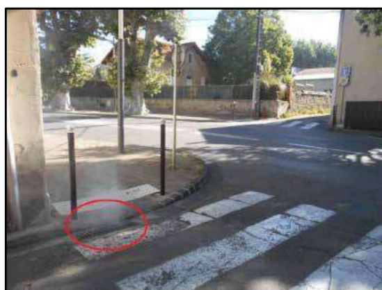
Figure 3 : Exemples d'anomalies décelées lors des tests à la fumée
