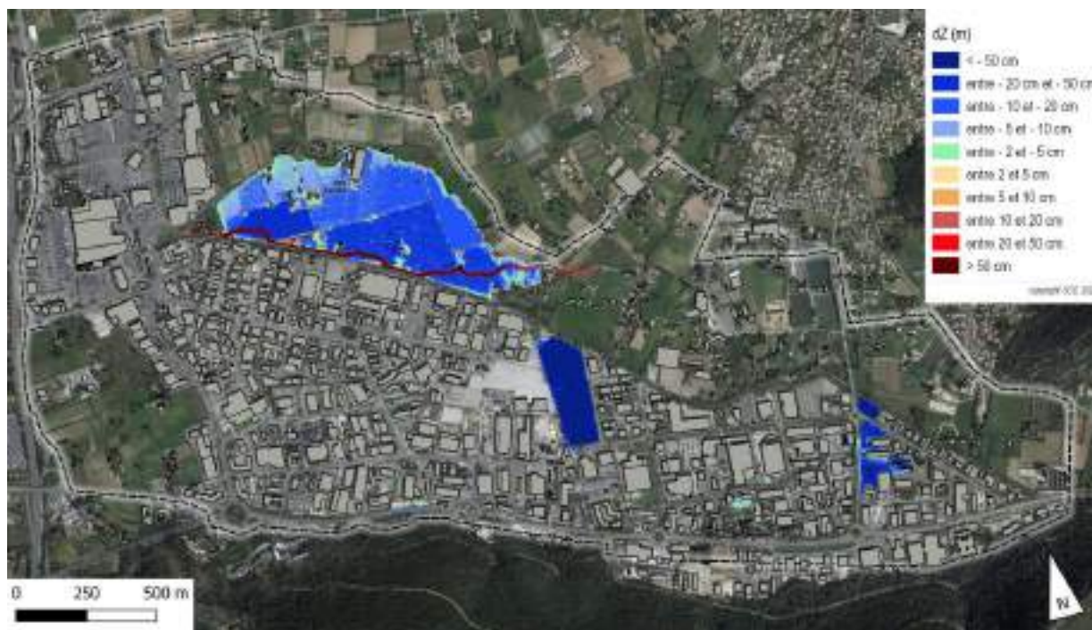
Figure 11 : Cartographies établissant l'évolution des hauteurs de submersion du fait du projet de renaturation (variante 2) suite à une pluie d'occurrence 5 ans.
