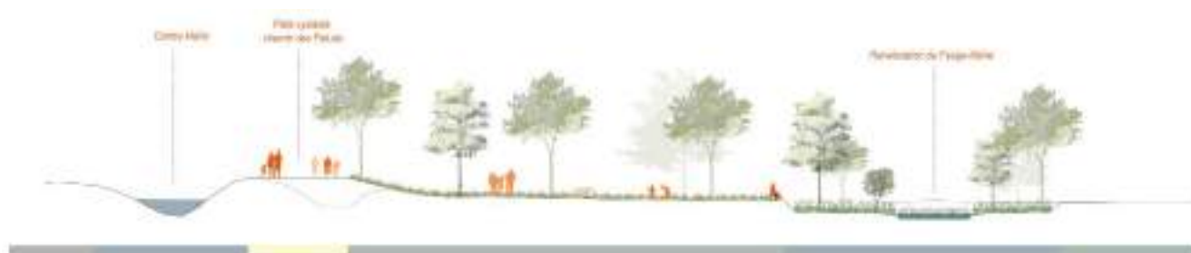
Figure 13 : Profil en travers établissant les conditions de renaturation du Fauge Maire au sein de l'actuelle plaine agricole au nord de la ZI des Paluds.
