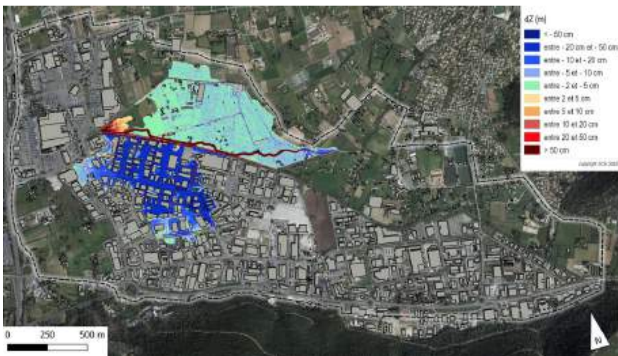
Figure 12 : Cartographie établissant l'évolution des hauteurs de submersion du fait du projet de renaturation (variante 2) suite à une pluie d'occurrence 100 ans.
