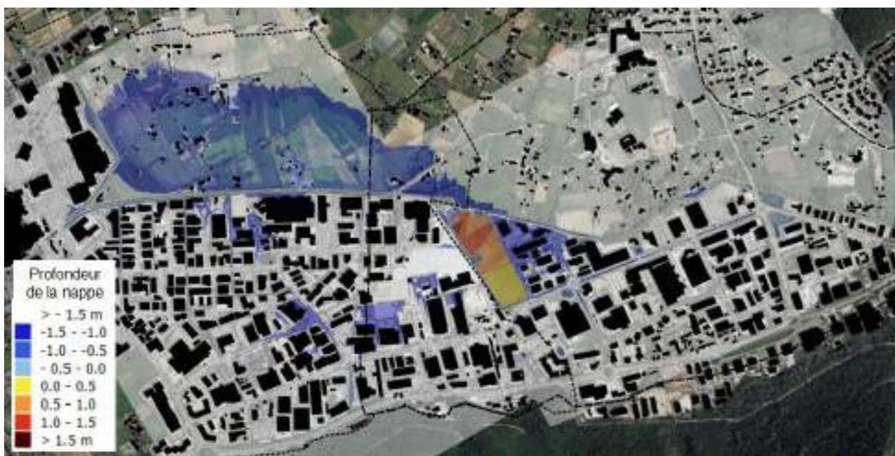
Figure 7 : Cartographie indiquant la profondeur indicative de la nappe haute par valorisation des travaux du BRGM en 2014
