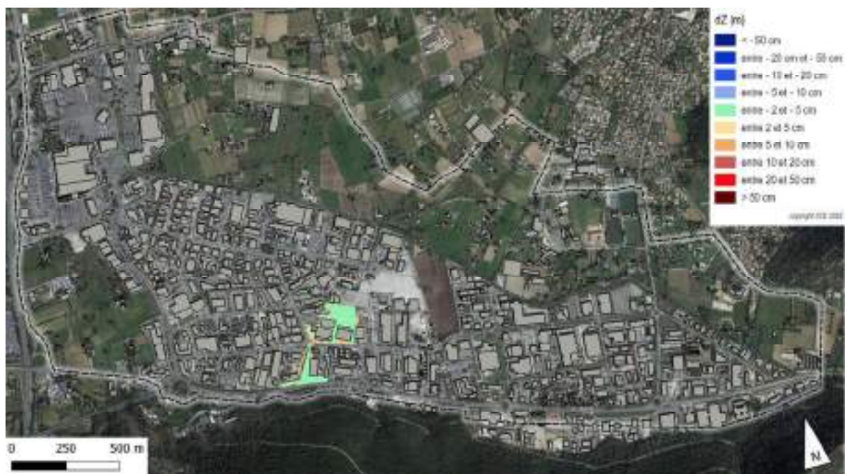
Figure 89 : Evolution des hauteurs de submersion pour un événement de pluie d'occurrence 2 ans – Piste 4
