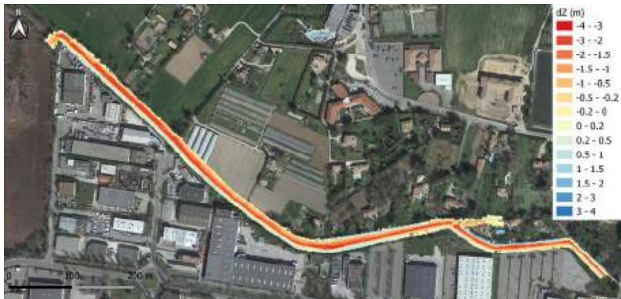
Figure 16 : Mouvement de terre à envisager dans le cadre du projet de renaturation de la Maire au nord de la ZA de la Plaine de Jouques (piste 7).
