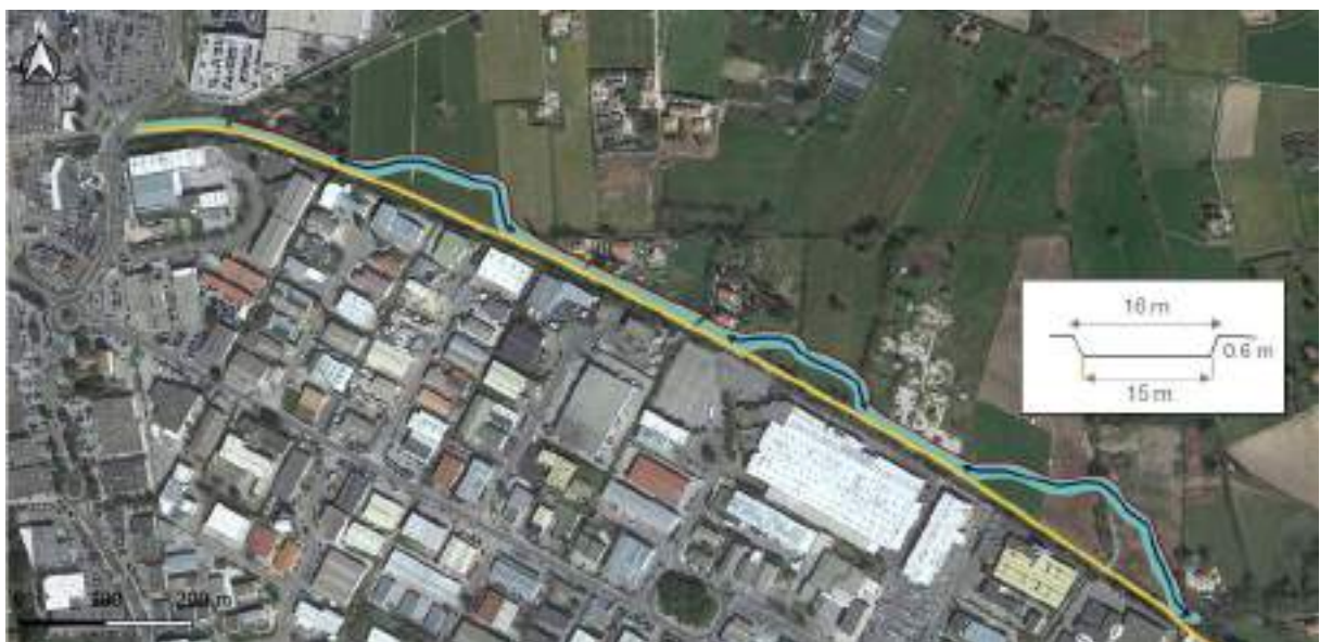
Figure 24 : Caractéristiques dimensionnelles du projet de renaturation du Fauge Maire sur la partie aubagnaise (piste 11).
