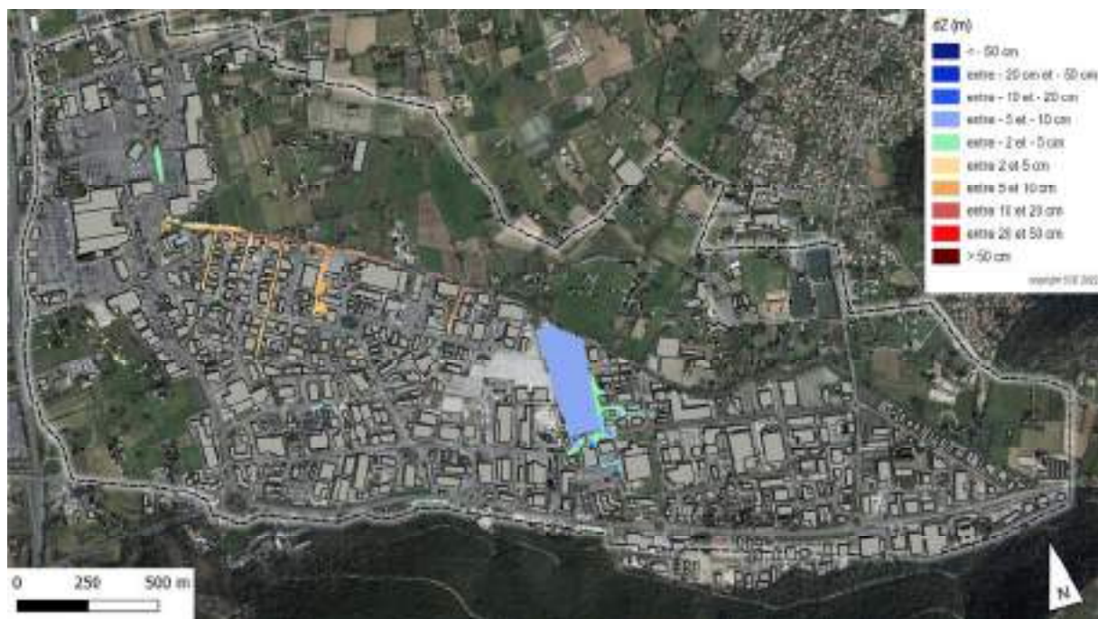
Figure 38 : Evolution des hauteurs de submersion pour un événement de pluie d'occurrence 30 ans – Piste 2
