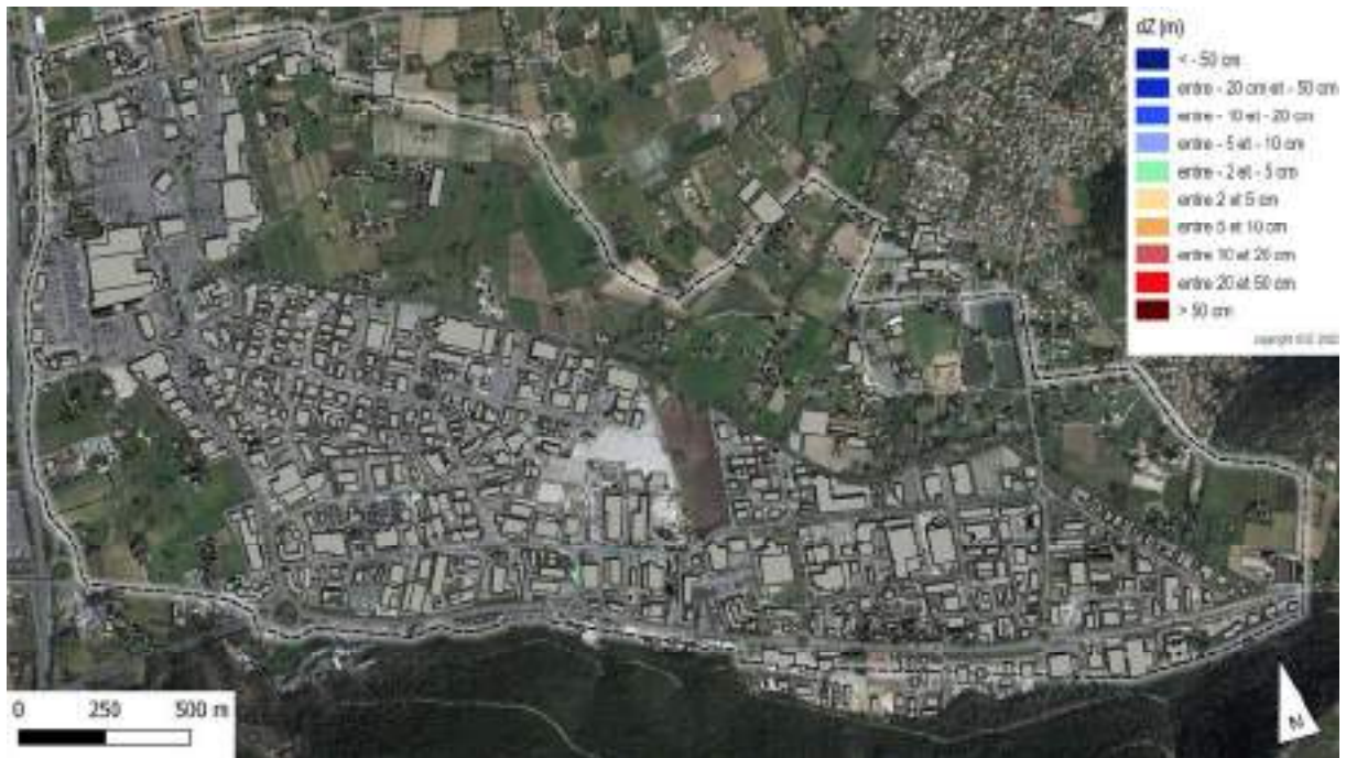
Figure 41 : Evolution non perceptible des hauteurs de submersion pour un événement de pluie d'occurrence 30 et 100 ans – Piste 13 (dZ compris entre -2 et +2 cm)
