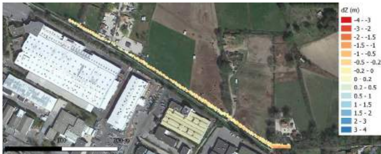
Figure 19 : Mouvement de terre à envisager pour araser le merlon en rive droite du Fauge Maire au nord de la ZI des Paluds (piste 8).
