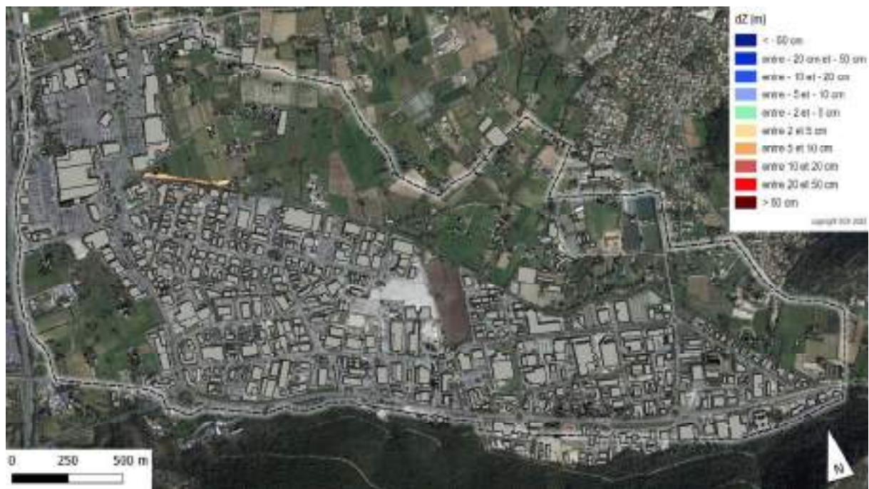
Figure 95 : Evolution des hauteurs de submersion pour un événement de pluie d'occurrence 10 ans – Piste 3
