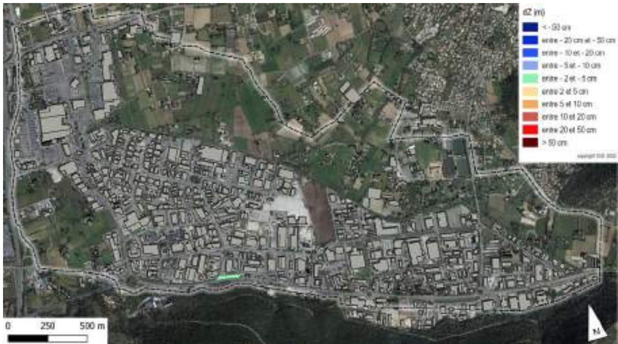
Figure 90 : Evolution des hauteurs de submersion pour un événement de pluie d'occurrence 10 ans – Piste 4
