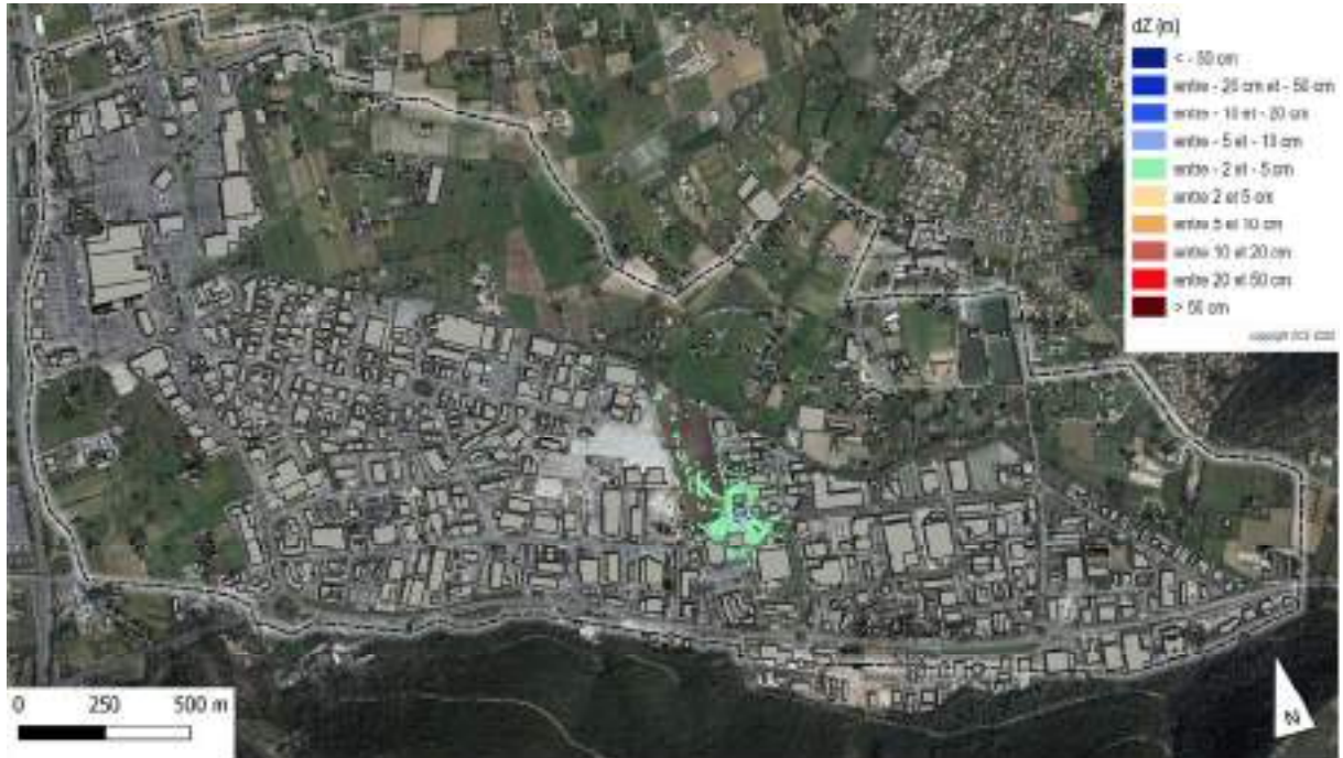
Figure 36 : Evolution des hauteurs de submersion pour un événement de pluie d'occurrence 100 ans – Piste 1
