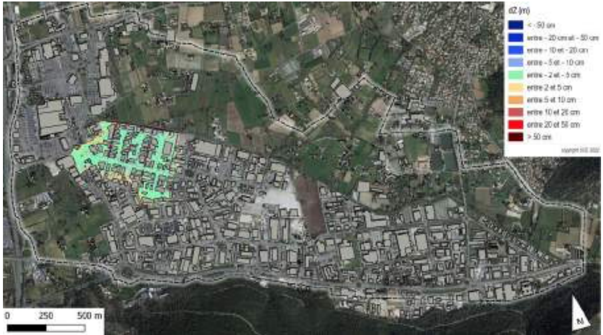
Figure 76 : Evolution des hauteurs de submersion pour un événement de pluie d'occurrence 100 ans – Piste 11
