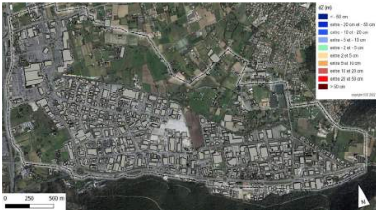
Figure 59 : Evolution des hauteurs de submersion pour un événement de pluie d'occurrence 100 ans – Piste 8
