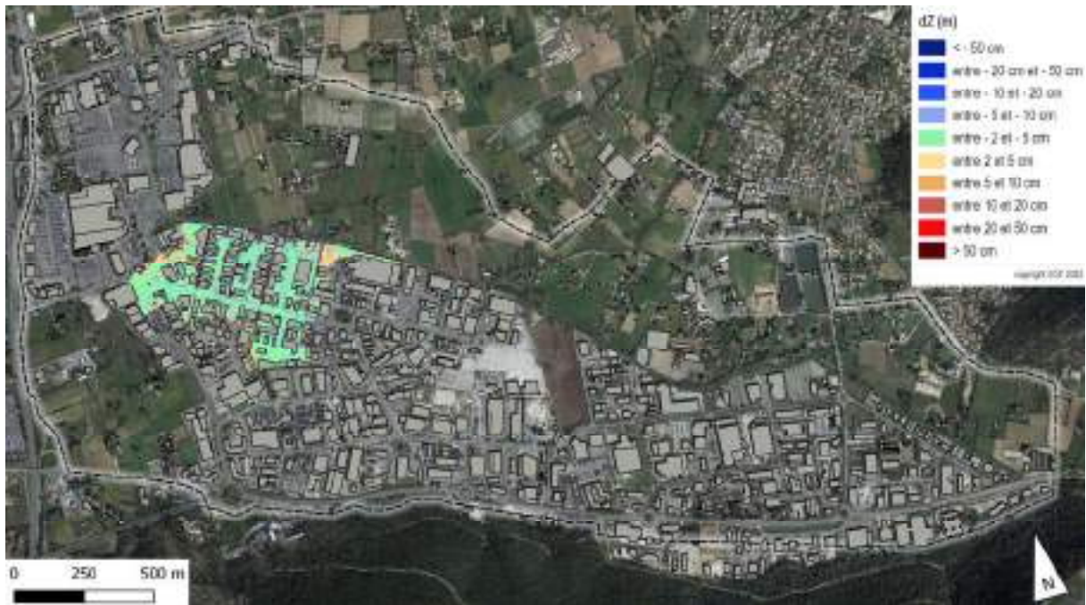
Figure 80 : Evolution des hauteurs de submersion pour un événement de pluie d'occurrence 100 ans – Piste 12
