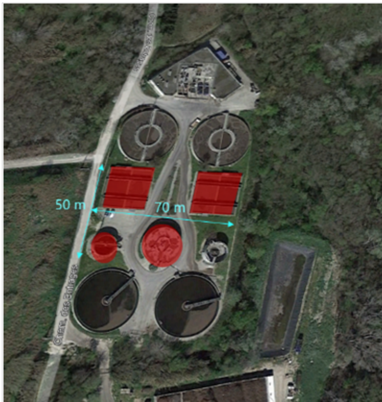
Figure 13 : Ouvrages et bâtiments démolis dans le cadre des travaux (en rouge)
