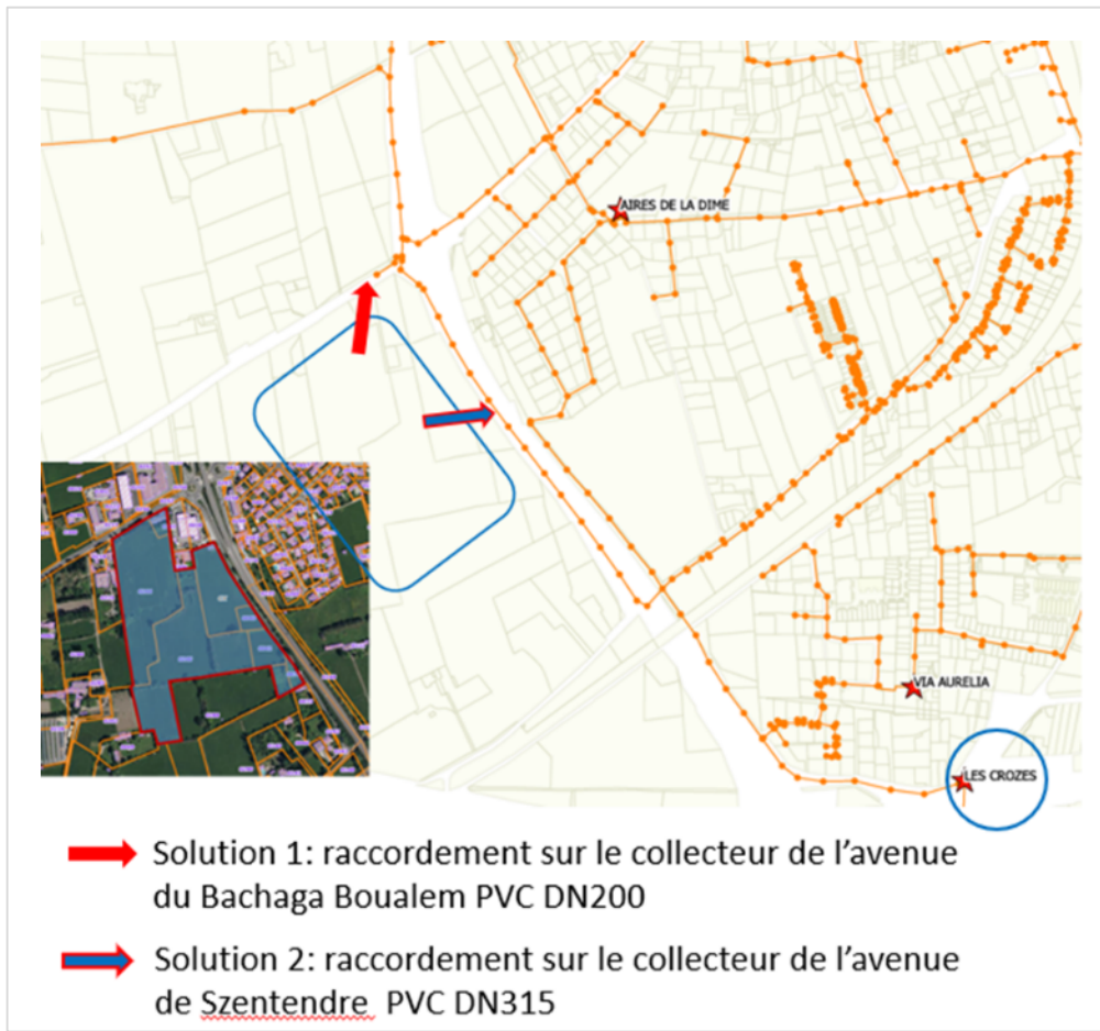
Figure 16 : Scénario raccordement du nouvel hôpital
