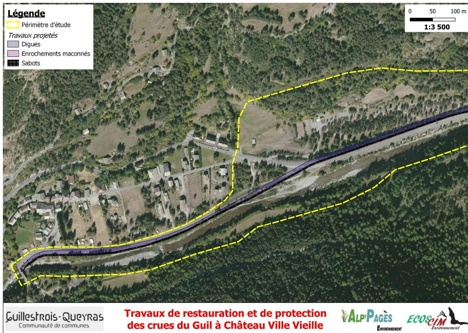
Fig. 116. Positionnement des travaux de protection - Aval
