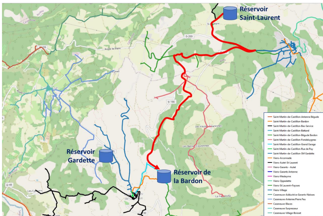
Figure 67 Carte de principe du secours du réservoir de la Bardon depuis Viens
