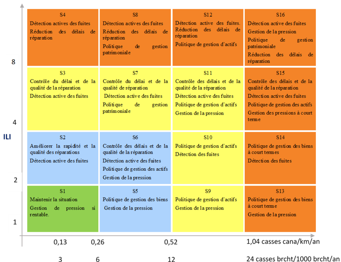
Figure 12 Diagramme de choix des actions à mettre en œuvre pour réduire les volumes de fuite d'un secteur dont l'ILI et le nombre de casse annuel sont connus
