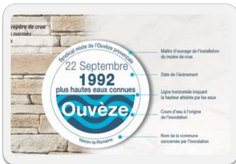
Figure 13 Macaron repère de crues Ouvèze
