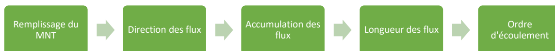
Figure 24 - Géo-traitement hydrologiques utilisés pour la définition des zones de dépression et le calcul des écoulements théoriques de surfaces
