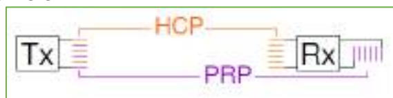
Figure 15 - Schéma de principe du DUALEM
