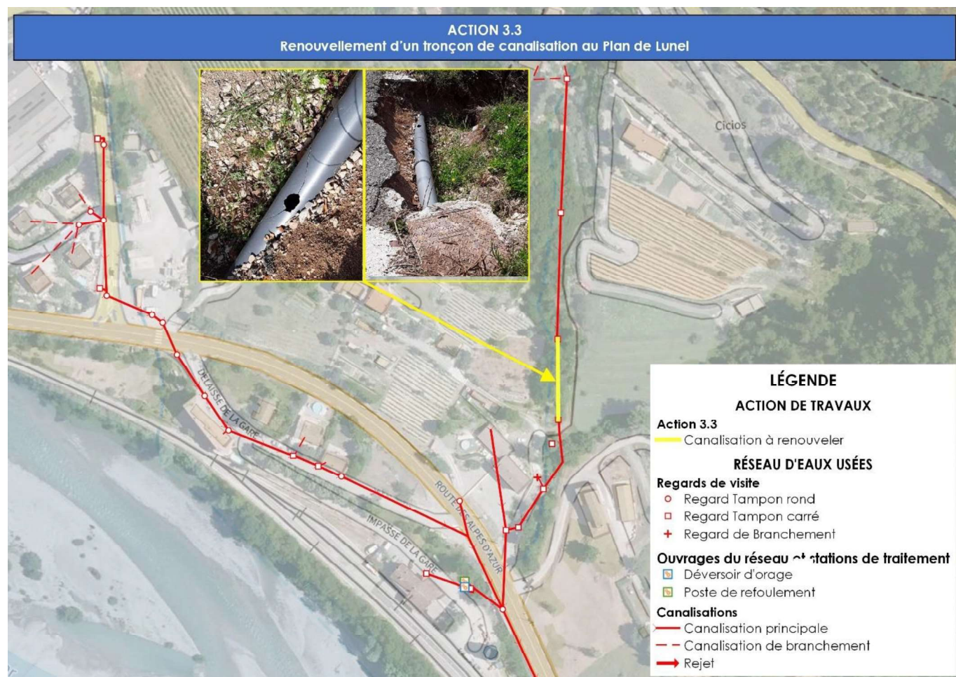
Figure 28 - Renouvellement tronçon EU dégradé secteur Plan de Lunel
