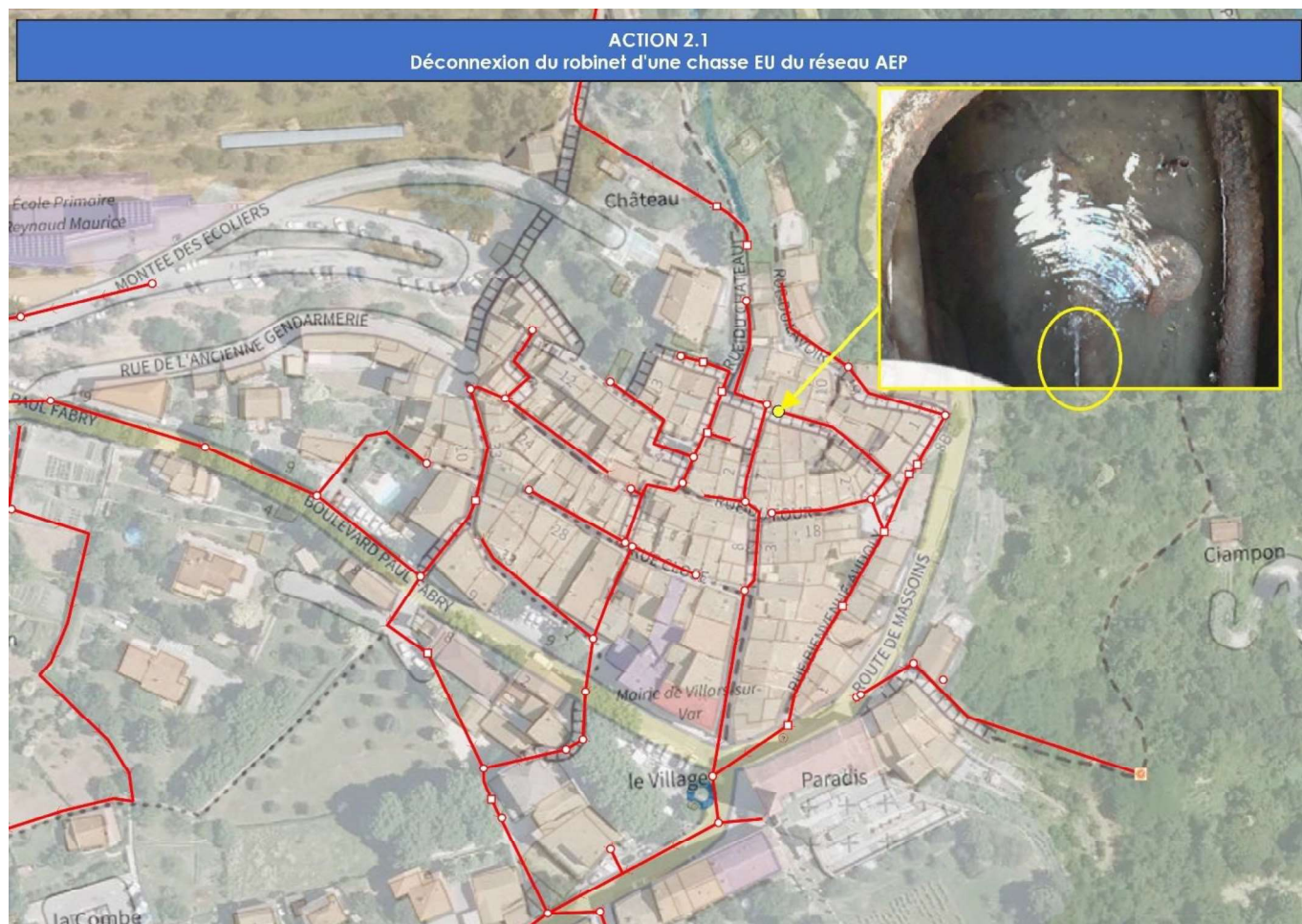
Figure 25 - Chasse déconnectée du réseau EU, toujours alimentée en AEP (robinet bloqué)
