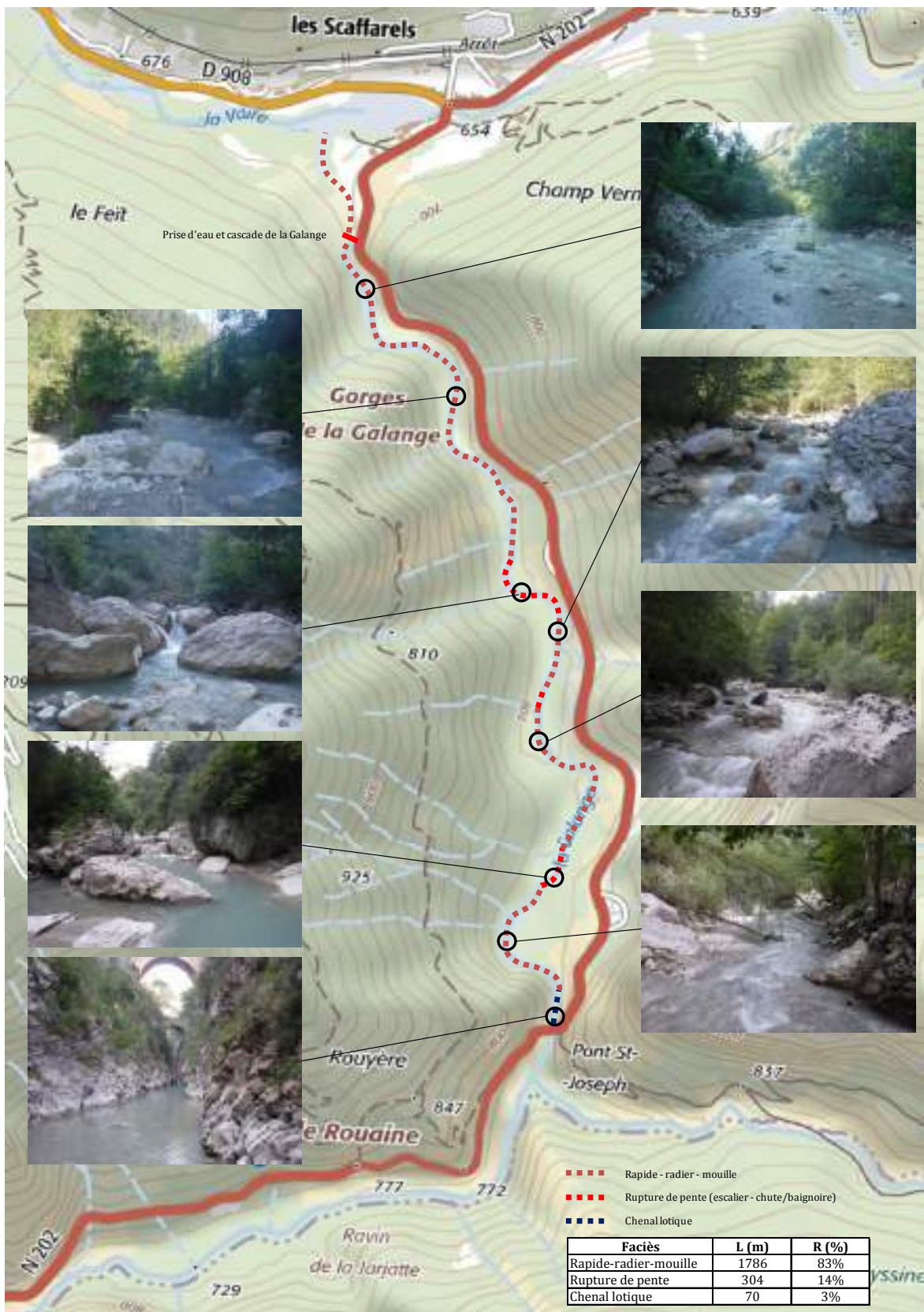
Figure 36 : Faciès de la Galange à l'amont de la prise d'eau et jusqu'au pont Saint-Joseph.
