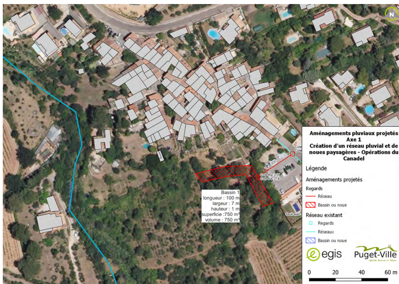
FIGURE 3 : LOCALISATION ET PRESENTATION DES AMENAGEMENTS PLUVIAUX PROJETES – AXE 1, OPERATION DU CANADEL
