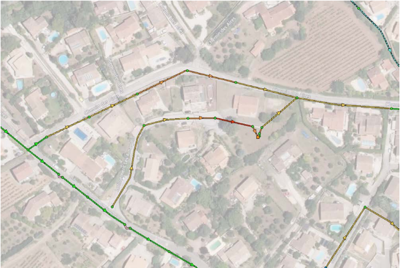
FIGURE 26 : MODELISATION HYDRAULIQUE DU RESEAU PROJETE POUR UNE PLUIE DECENNALE
