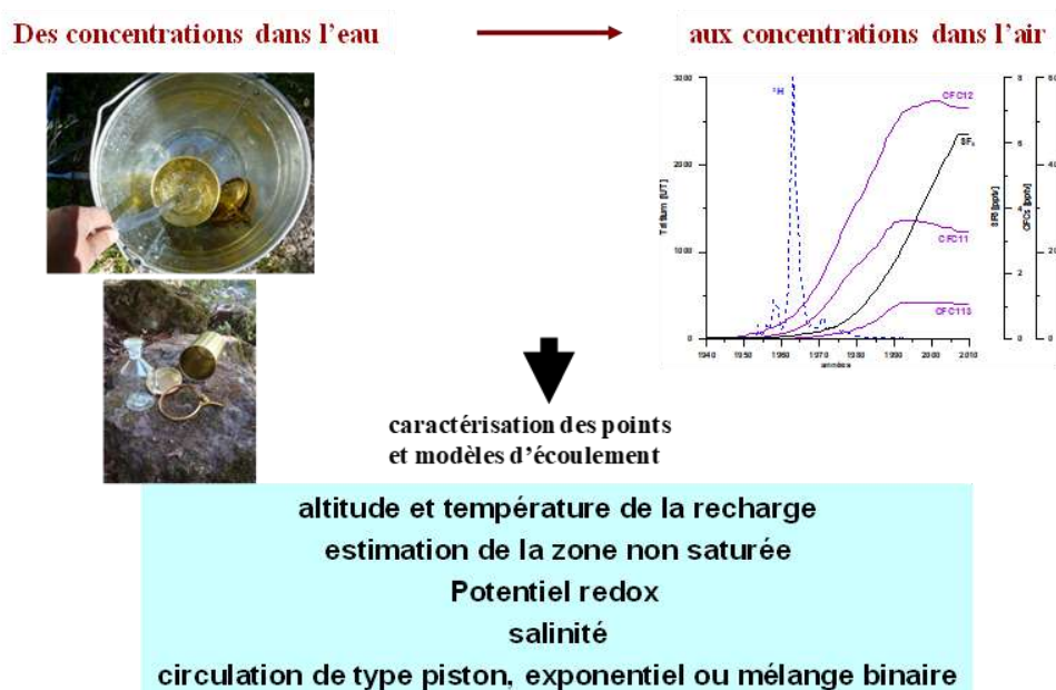
Figure 138 : Schéma de réalisation de l'estimation des âges apparents des eaux souterraines par traceurs chimiques
