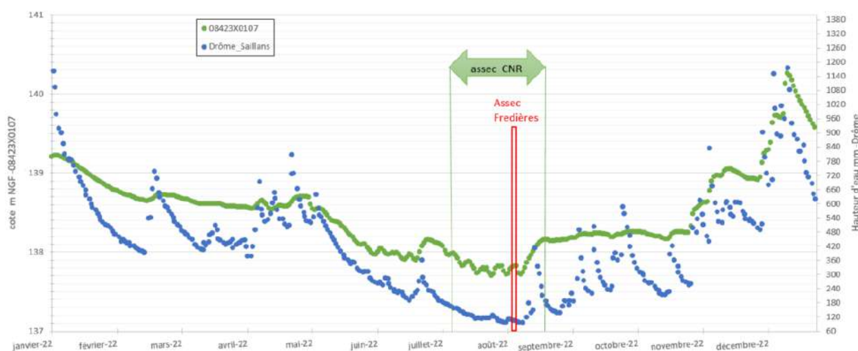
Figure 38 : Chroniques du piézomètre 08423X0107-Grâne (cote en m NGF) et hauteurs d'eau mesurées à Saillans (hauteur instantanée minimale journalière) pour l'année 2022
