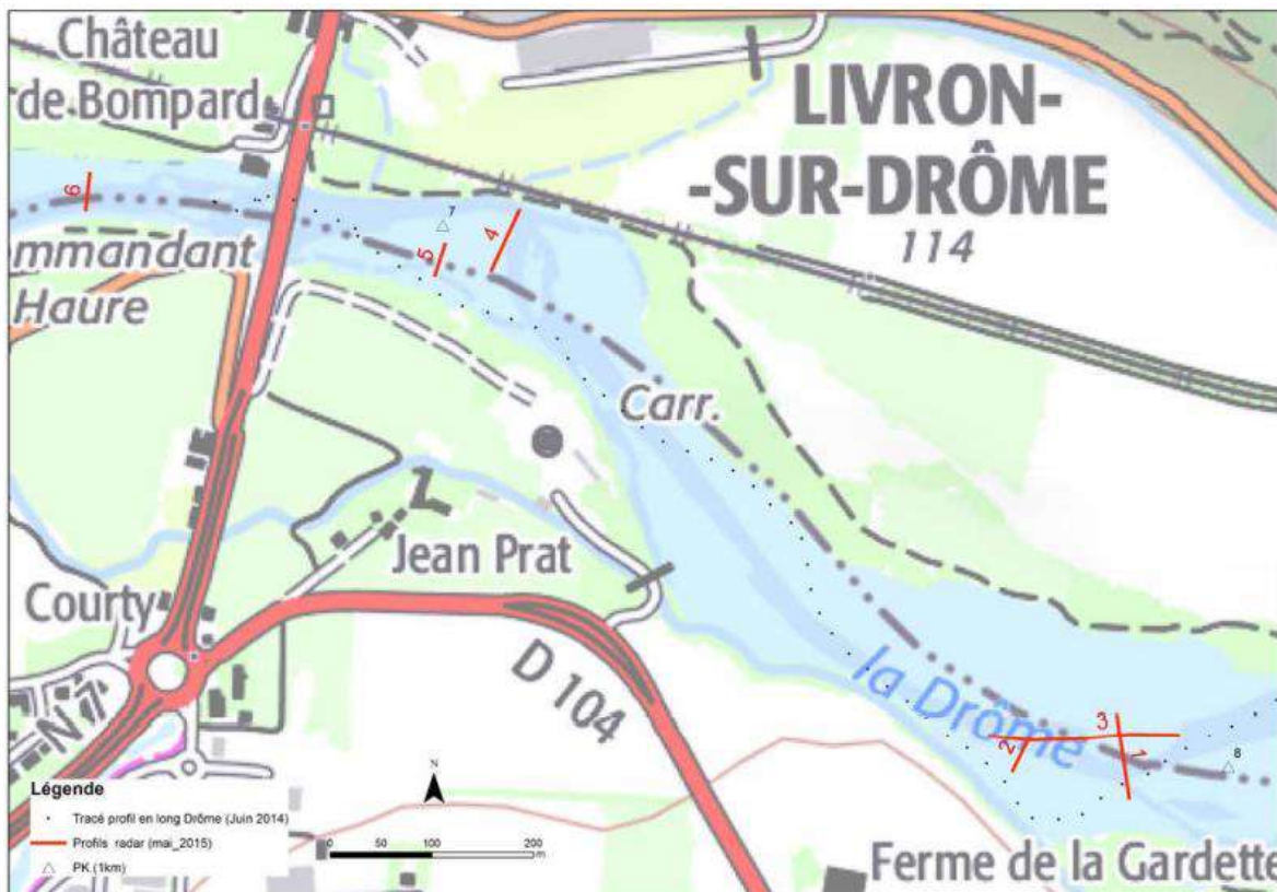
Figure 16 : Localisation des radargrammes en amont et en aval du pont de Livron (Source : ZABR, 2016)
