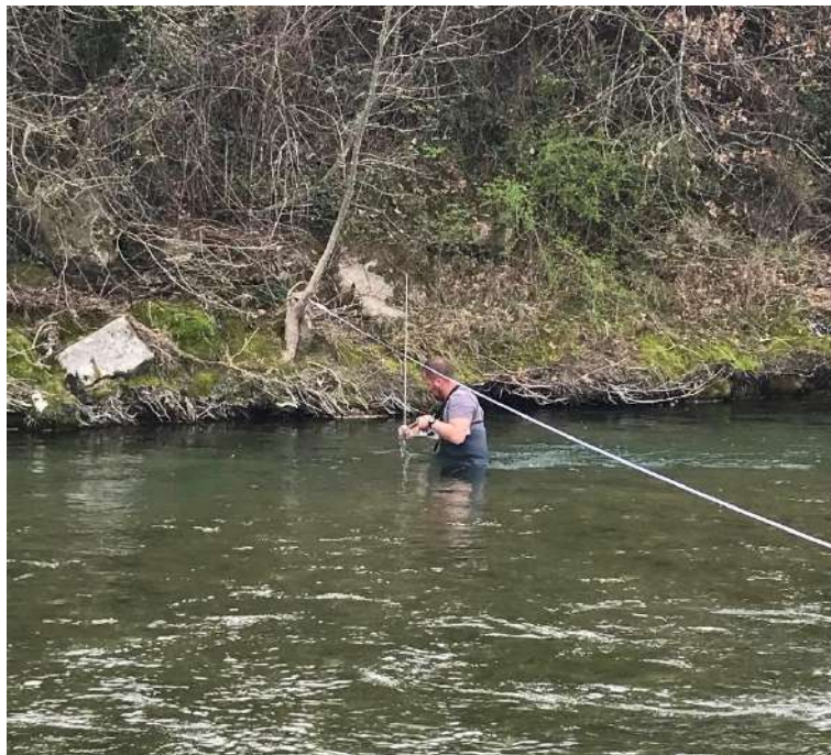
Figure 31 : Mesures de débit par jaugeage sur la Drôme le 29/03/2022
