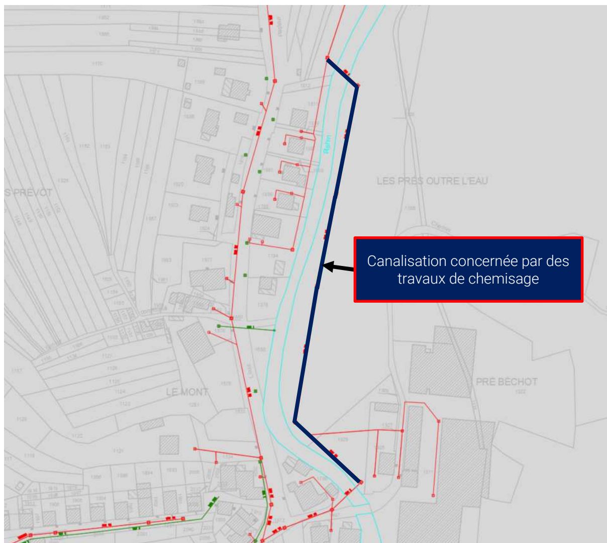
Figure 20 : Schéma des travaux préconisés Pré de l'Outre l'Eau
