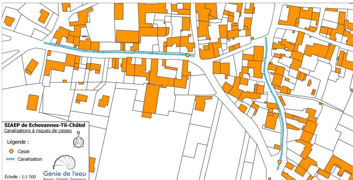
Figure 18 : Identification des canalisations à risque de casse sur la commune de Til-Châtel
