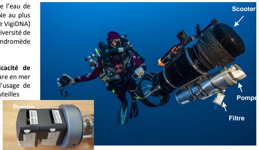
Figure 2 : Pompe étanche conçue par Andromède Océanologie et l'Université de Montpellier.
